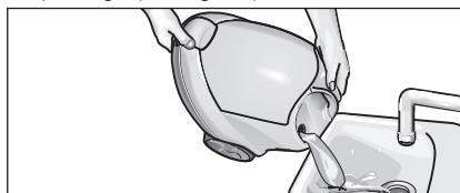
Fig. 13 : rinçage de la chaudière
