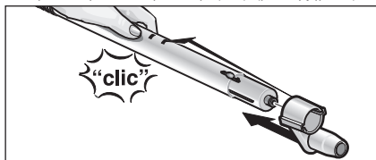
Abb. 4: Τοποθέτηση του άγκιστρου στάθμευσης
