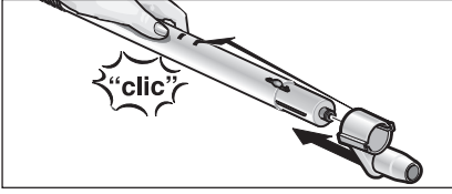
Şekil 4: Park kancasının takılması
