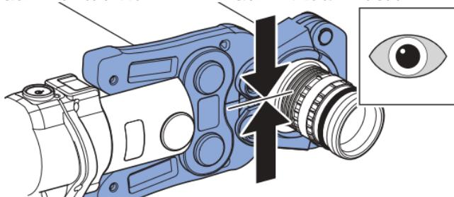
**3** 打开 Geberit挤压口适配器，将之脱离 Geberit 挤压口。
