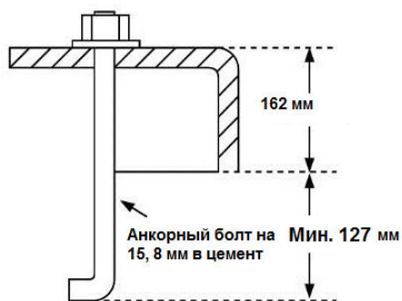
Схема крепления основания анкерными болтами
