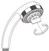
2. Svitare la parte centrale del filtro con la chiavetta in dotazione.
