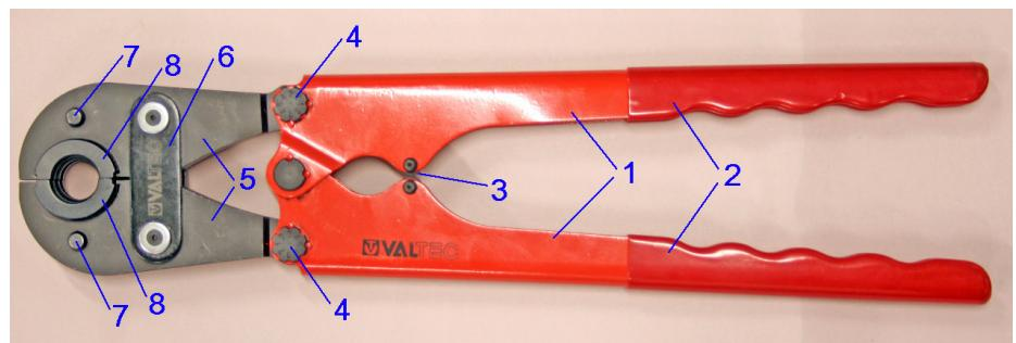
Монтажное усилие, приложенное к рукояткам (1) по принципу рычага передается на полуобоймы (5), в которых закрепляются пресс-вкладыши (8). Вкладыши фиксируются кнопочными фиксаторами (7). Планка (6) стягивает
