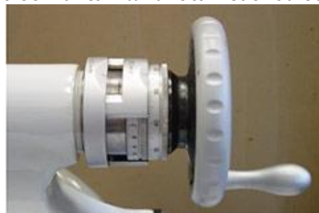
Рис.36 Нониус пиноли задней бабки
