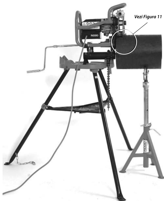
Figura 12 – Mașină de șanfrenare fixă, țeavă scurtă, un stativ pentru țeavă
