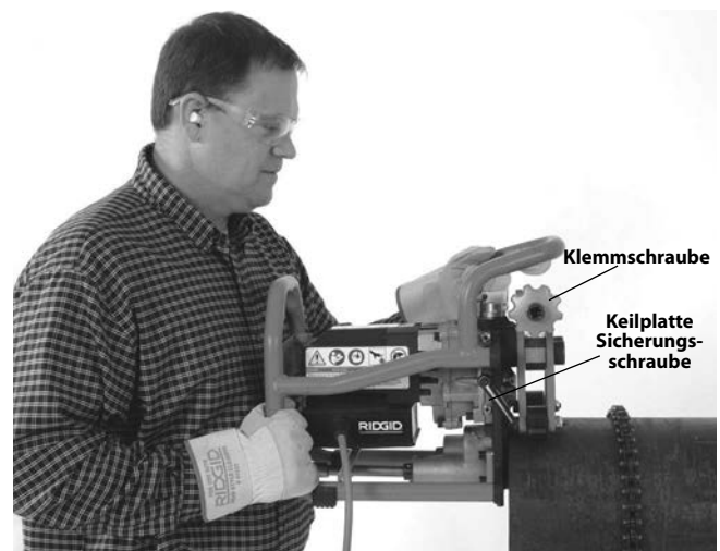
Abbildung 15A – Platzieren des Anfasgeräts am Rohr
