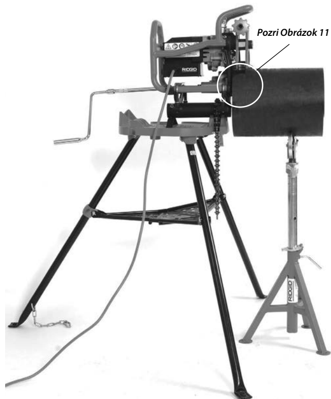
Obrázok 12 – Upevnená úkosovačka, krátka rúrka, jeden stojan na rúrky
