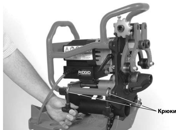
Рис. 9 – Крепление станка для снятия фаски к держателю
