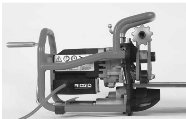
Figura 16B – Montarea mașinii de șanfrenare pe placă
