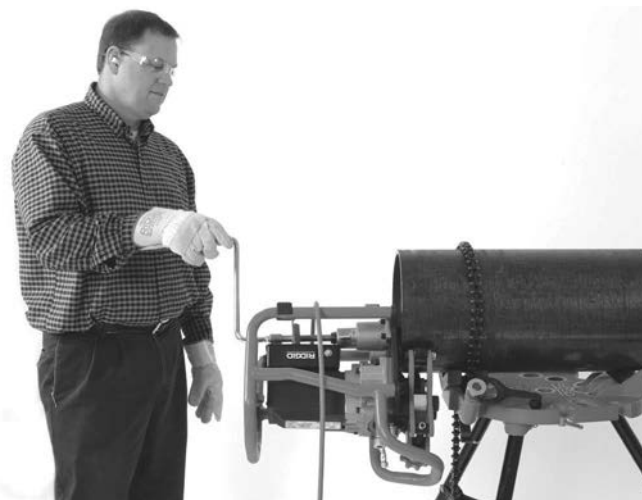
Abbildung 20B – Anfasen (fixiertes Werkstück/bewegtes Anfasergerät)
