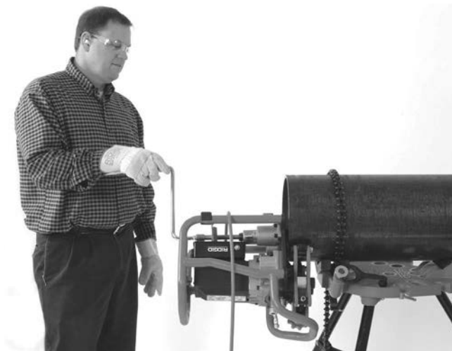
Figur 20B – Affasningsproces (fast arbejdsemne/bevægeligt affasningsværktøj)
