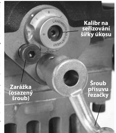
Obrázek 18 – Nastavení kalibru na seřizování šířky úkosu
