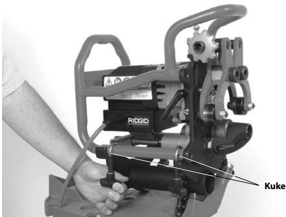
Slika 9 – Učvršćivanje alata na prilagodnik
