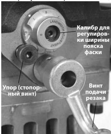
Рис. 18 – Установка калибра для регулировки ширины пояска фаски
