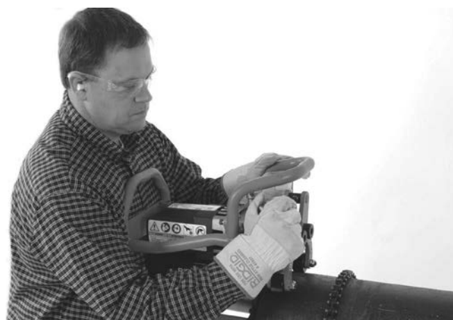
Figura 17A – Aperto Manual do Parafuso de Aperto
