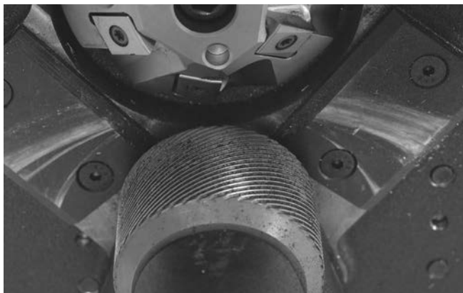
Figura 22 – Limpar Rolos de Estriagem
