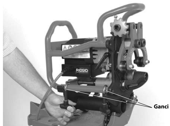
Figura 9 – Fissaggio della smussatrice all'adattatore
