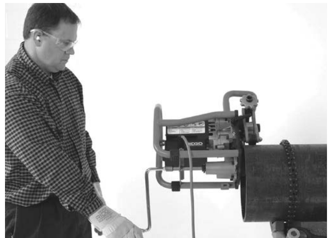
Abbildung 20A – Anfasen (fixiertes Werkstück/bewegtes Anfasgerät)
