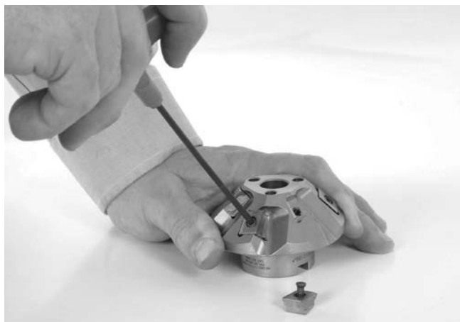
Obrázok 24 – Výmena rezných vložiek
