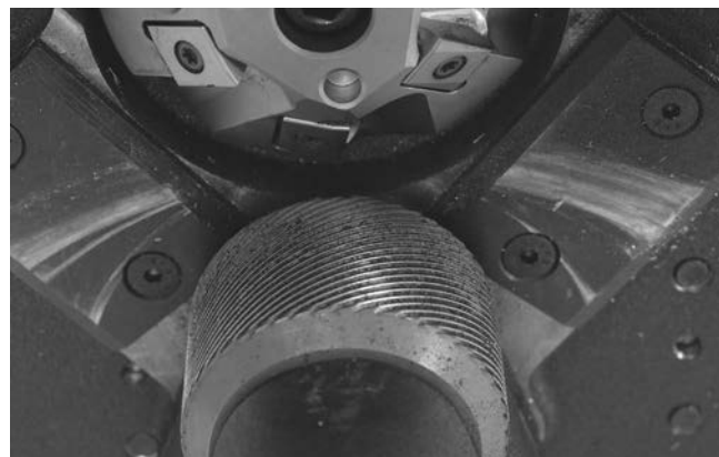
Slika 22 – Čisti utori pogonskog valjka
