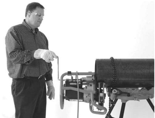
Figur 20B – fasing (Fast arbeidsemne / Bevegelig fasemaskin)
