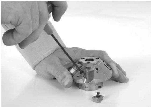
Figura 24 – Sostituzione degli Inserti della taglierina
