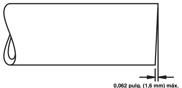
Figura 5 – Forma recta que debe tener el extremo del tubo
