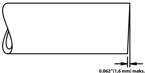
Figur 5 – Krav til rørets rettvinklethet
