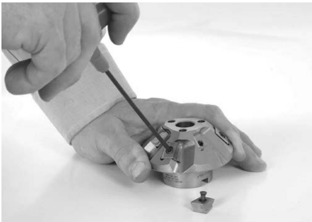
Abbildung 24 – Wechseln der Schneideinsätze
