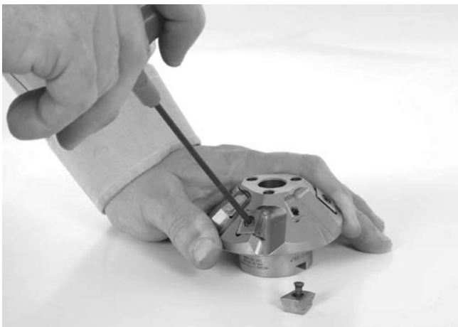
Rys. 24 – Wymiana płytek wieloostrowych
