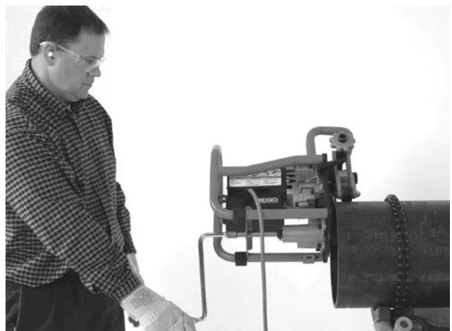
Obrázok 20A – Úkosovanie (uchytený obrobok / pohybuje sa úkosovačka)
