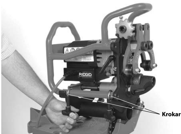
Figur 9 – Hålla fast avfasaren vid adaptern
