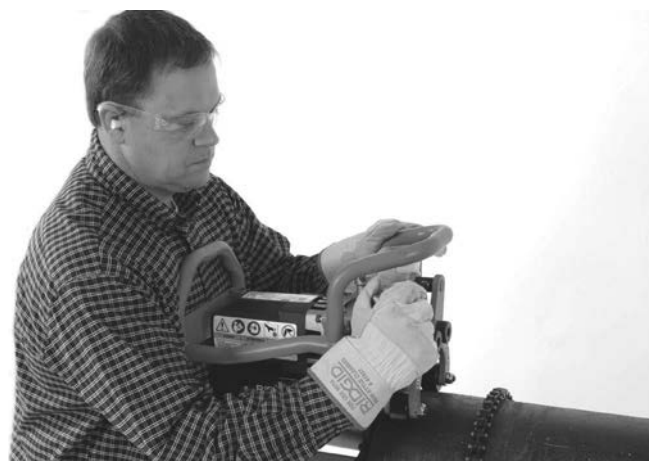
Figure 17A – Tilspænding af spændeskruen med håndkraft
