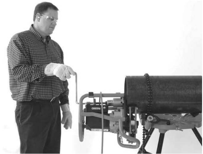
Рис. 20В – Операция по снятию фаски (закрепленная заготовка/перемещение станка)
