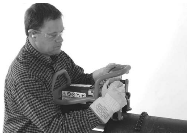
Figuur 17A – Klemschroef met de hand vastdraaien
