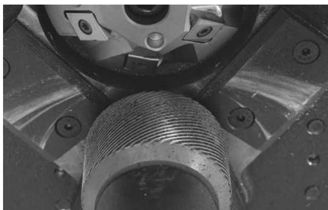
Figura 22 – Pulire le zigrature del Rullo di trasmissione
