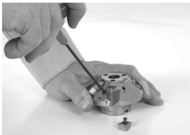
Εικόνα 24 – Αντικατάσταση κοπτικών ενθέτων
