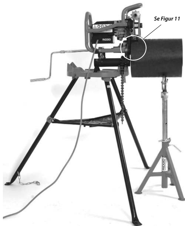
Figur 12 – Fast affasningsværktøj, kort rør, en rørstøtte
