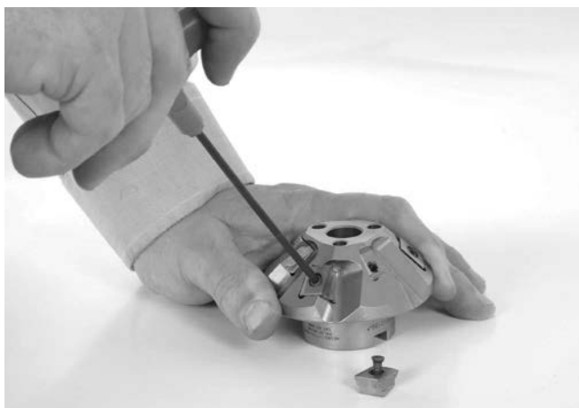
Slika 24 – Zamena reznih umetaka
