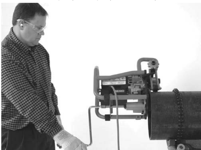
Obrázek 20A – Postup úkosování (fixní opracovávaný kus/pohyblivá úkosovačka)
