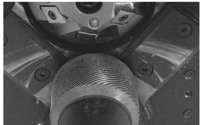
Obrázek 22 – Vyčistěte rýhování hnacího válce
