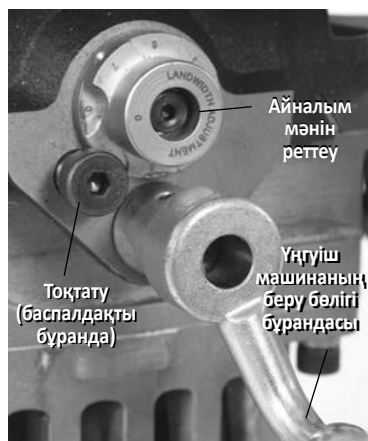
18-сурет – Айналым мәнін реттеудің өлшеуіш параметрі
