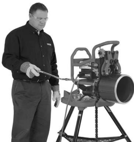
Figura 20C – Operação de Biselagem (Biselador Fixo/ Tubo Rotativo)
