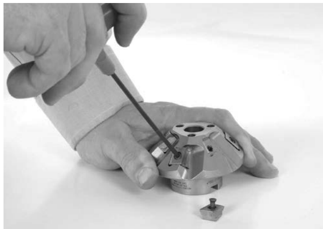
Figur 24 – Udskiftning af skæreindsatser
