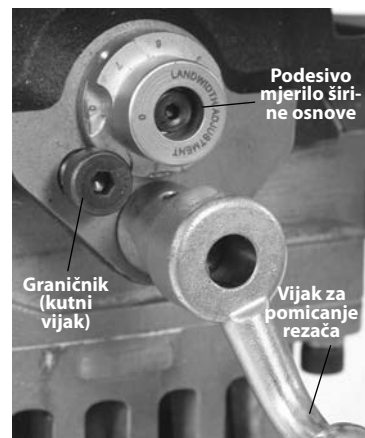
Slika 18 – Podešavanje podesivog mjerila širine osnove
