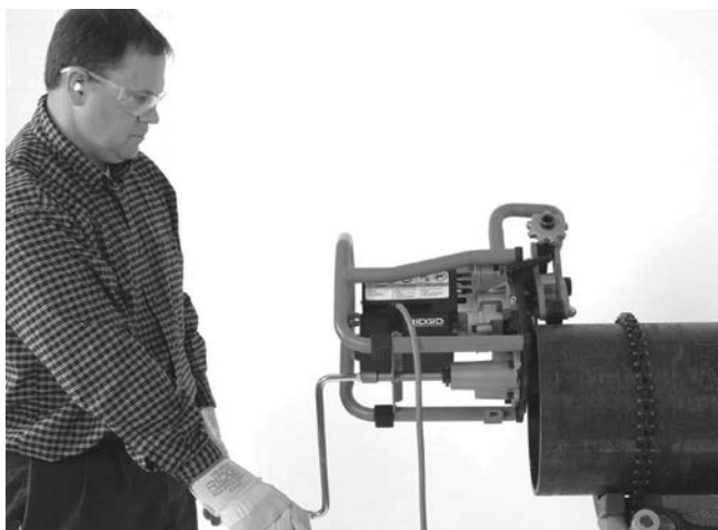
Figur 20A – Avfasningsfunktion (fast arbetsstycke/rörlig avfasare)
