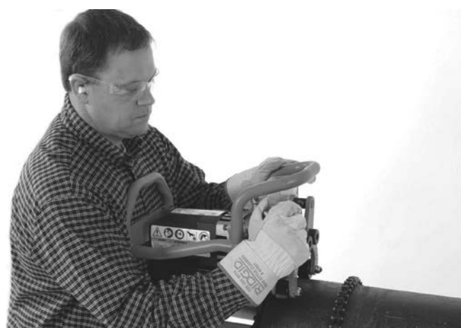
17A ábra – A befogócsavar megszorítása kézzel
