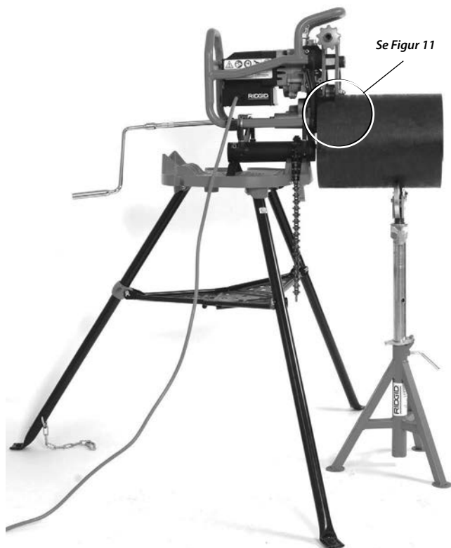
Figur 12 – Fast fasemaskin, kort rør, ett rørstativ
