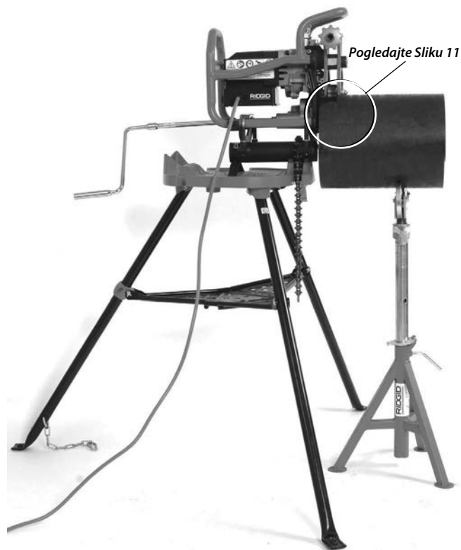
Slika 12 – Fiksiran alat za obaranje ivica, kratka cev, jedno postolje cevi
