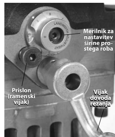
Slika 18 – Nastavitev merila širine prostega roba
