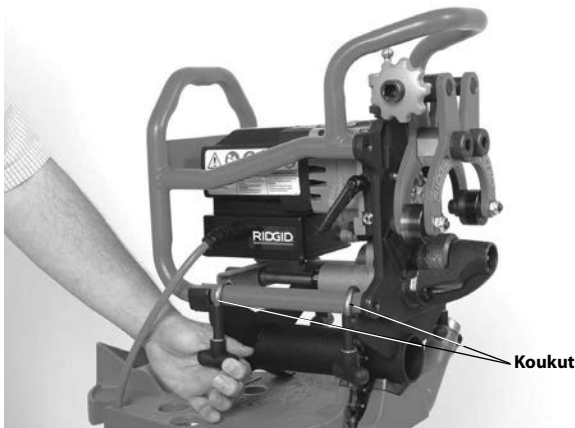
Kuva 9 – Viisteleikkurin kiinnitys adapteriin
