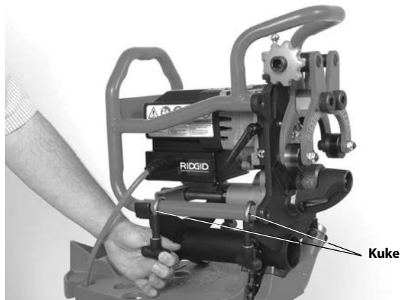
Slika 9 – Pričvršćivanje alata za obaranje ivica za adapter
