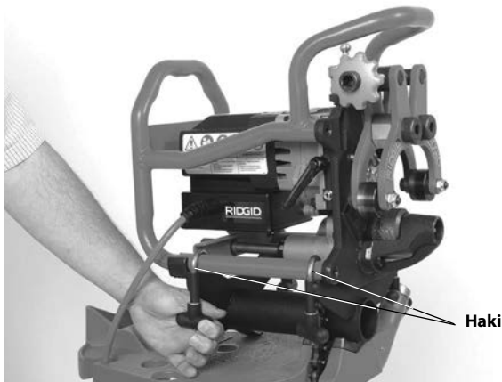
Rys. 9 – Mocowanie ukosowarki w adapterze
