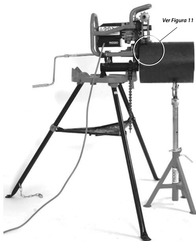
Figura 12 – Biselador Fixo, Tubo Curto, Um Suporte de Tubo
