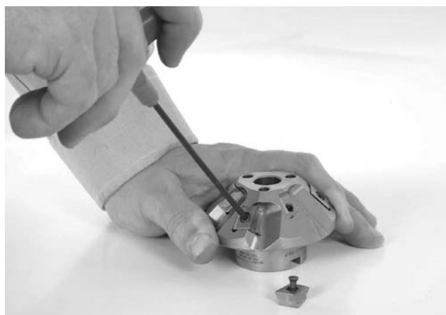
Obrázek 24 – Výměna řezacích vložek
