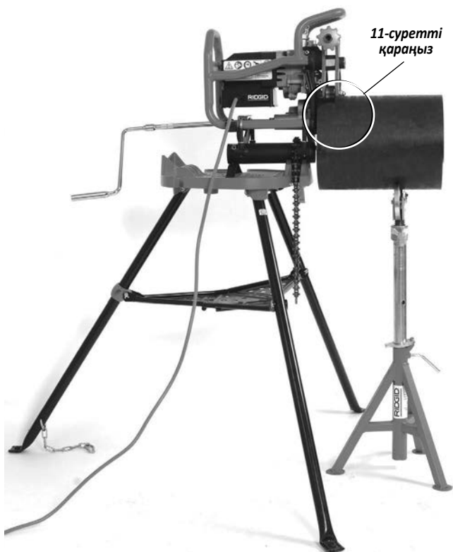
12-сурет – Тұрақты қиғаш кесу құралы, қысқа құбыр, бір құбыр білтесі
