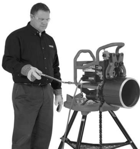
20C ábra – Leélezési művelet (Fix leélezőgép/Forgó cső)
