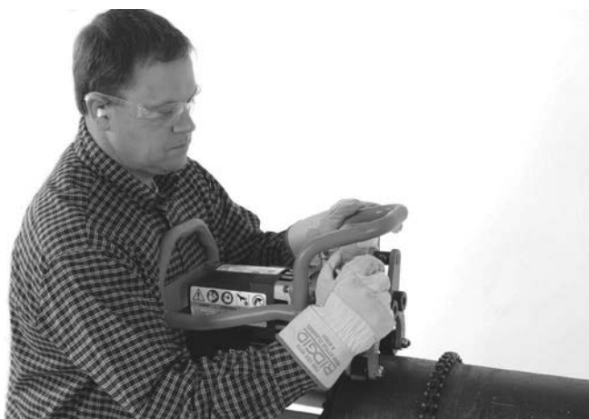
Figur 17A – Stram klemmeskruen til for hånd
