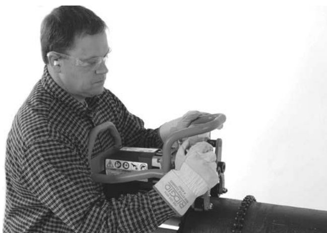
Kuva 17A – Kiristä kiristysruuvi käsin
