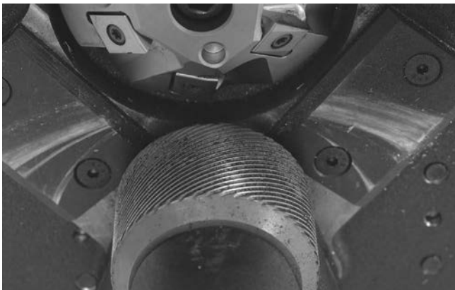
Abbildung 22 – Reinigen der Rändelung der Antriebsrolle
