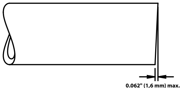
Figuur 5 – Rechtheidstolerantie van de pijp
