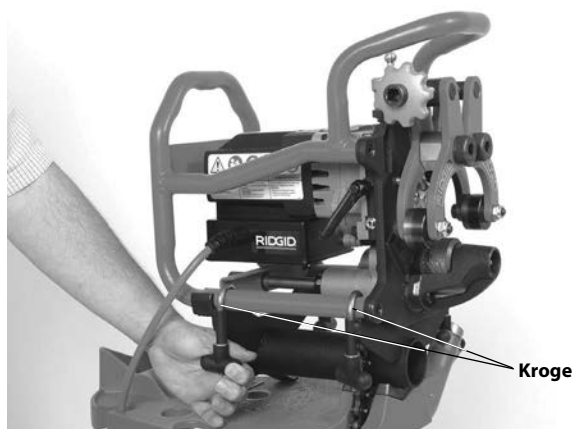
Figur 9 – Fastgørelse af affasningsværktøjet på adapteren
