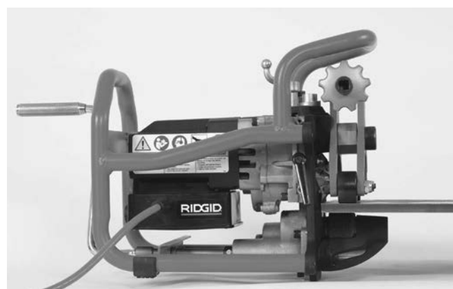
Figur 16B - Installere fasemaskinen på platen
