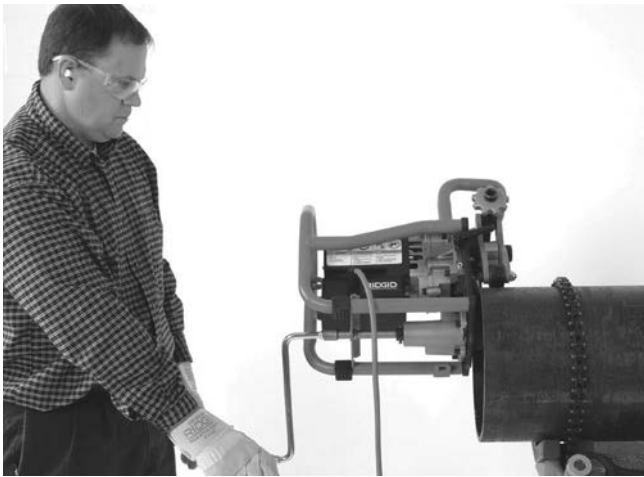
Εικόνα 20Α – Λειτουργία φρεζαρίσματος (Σταθερό τεμάχιο εργασίας/κινούμενο εργαλείο φρεζαρίσματος σωλήνων)
