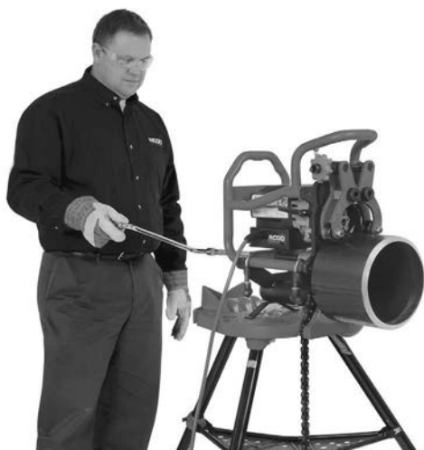
Slika 20C – Posnemanje robov (fiksni posnemovalac robov/vrteča cev)
