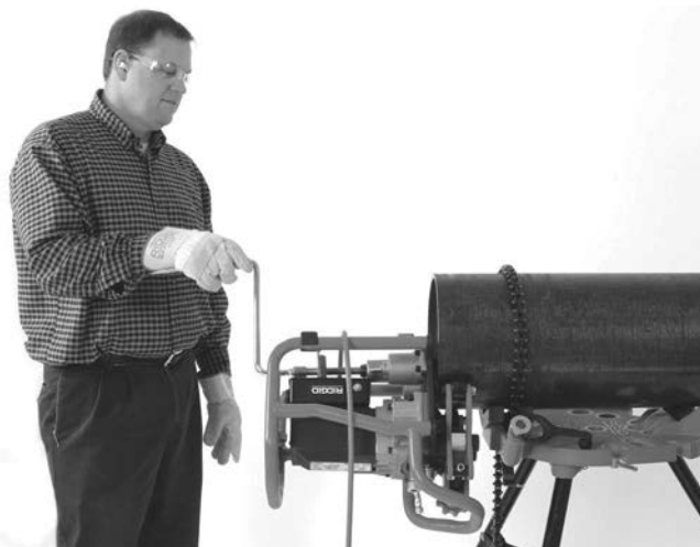
20В-сурет – Қиғаш кесу әрекеті (Тұрақты жұмыс нысаны/Қиғаш кесу құралын жылжыту)
