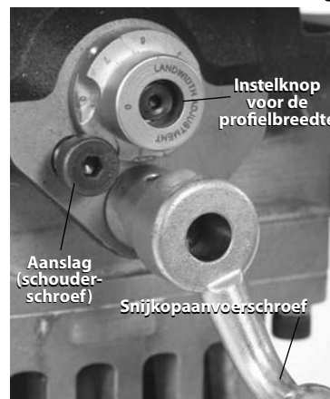
Figuur 18 – Instellen van de instelknop voor de profielbreedte
