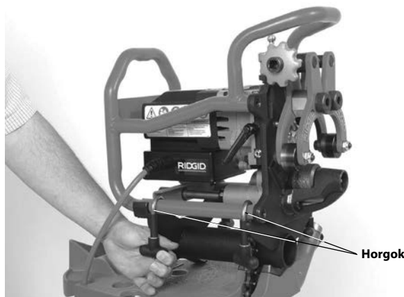
9. ábra – A leélező gép rögzítése az adapterre
