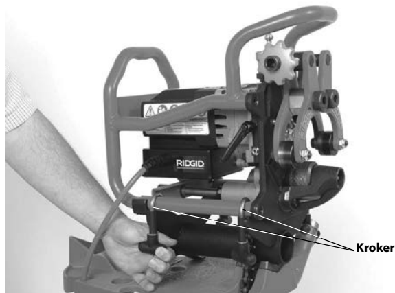
Figur 9 – Feste fasemaskinen til adapteren
