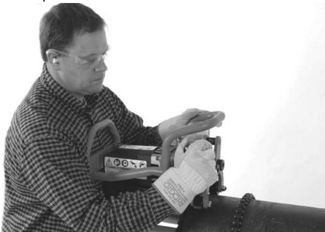
Obrázek 17A – Ručně dotáhněte upínací šroub
