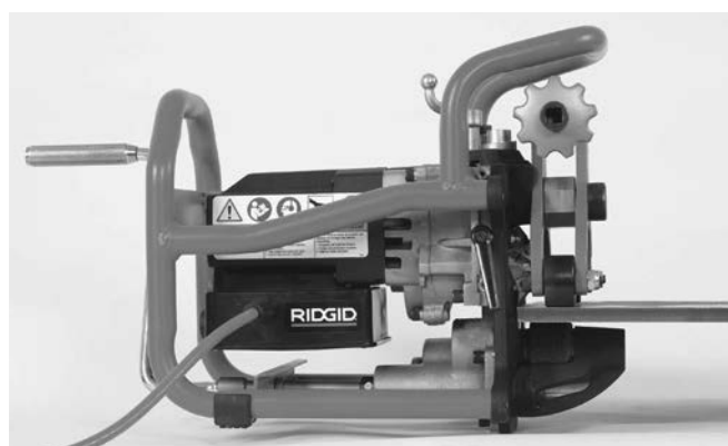
Figure 16B – Påmontering af affasningsværktøjet på en plade
