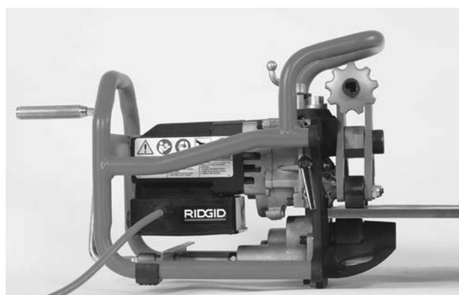
Slika 16B – Nameščanje posnemalec robov na ploščo
