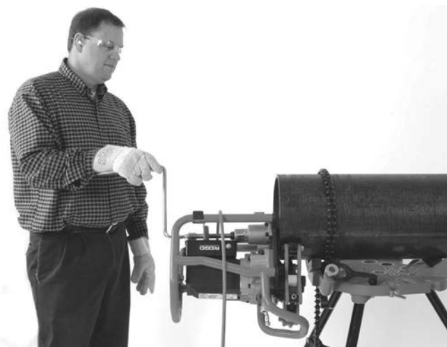
Figuur 20B – Afschuinen (Vastgezet werkstuk/Bewegend afschuinapparaat)
