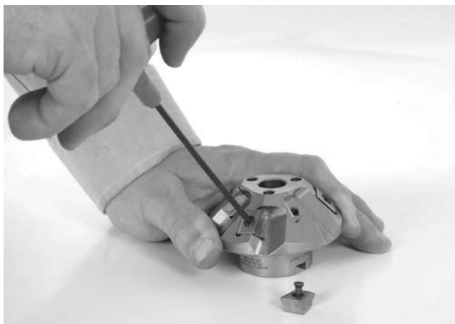
Slika 24 – Zamenjava rezalnih vstavkov
