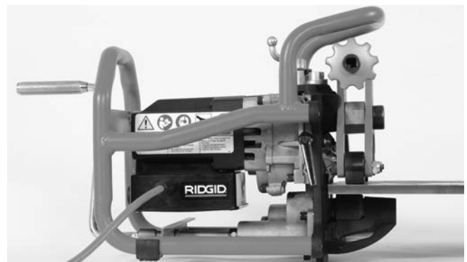
Figura 16B – Colocación de la biseladora sobre una chapa
