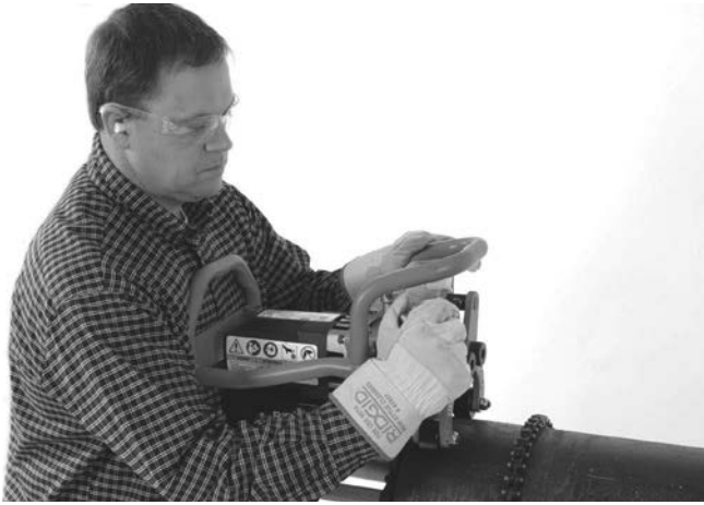
Şekil 17A – Sıkıştırma Vidasını Elle Sıkın
