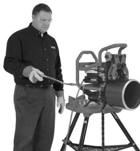
Obrázek 20C – Postup úkosování (fixní úkosovačka/otáčející se trubka)
