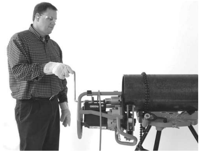
Kuva 20B – Viistäminen (kiinteä työkappale/liikkuva viisteleikkuri)
