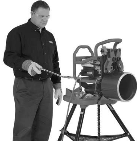
Şekil 20C – Pahlama İşlemi (Sabit Pahlama Makinesi/ Dönen Boru)
