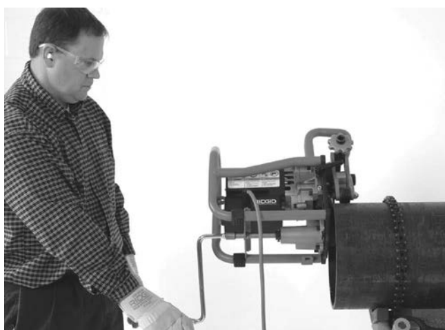
Rys. 20A – Czynnosc ukosowania (nieruchomy detal/poruszajaca sie ukosowarka)
