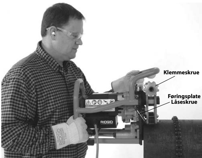
Figur 15A - Sette fasemaskinen på røret
