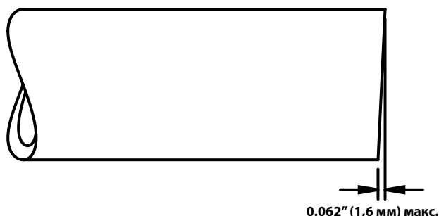
Рис. 5 – Требования к перпендикулярности торца трубы
