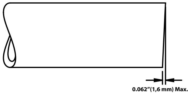
Figur 5 – Krav på rörets vinkelräthet
