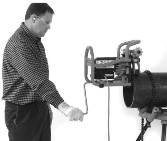
Figura 19 – Posizione corretta dell'operatore
