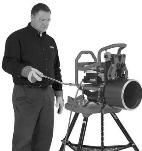
Obrázok 20C – Úkosovanie (uchytená úkosovačka / rotujúca rúrka)
