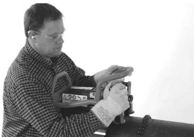
Рис. 17А – Затягивание зажимного винта от руки
