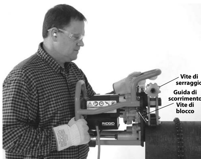
Figura 15A – Collocamento della Smussatrice sul Tubo
