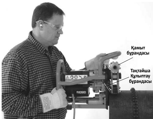
15A-суреті – Қиғаш кесу құралын құбырға орналастыру
