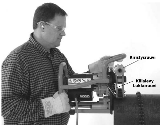
Kuva 15A – Viisteleikkurin asettaminen putkeen
