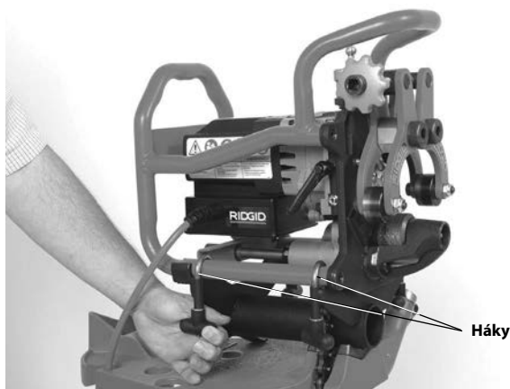
Obrázek 9 – Zajištění úkosovačky na adaptéru
