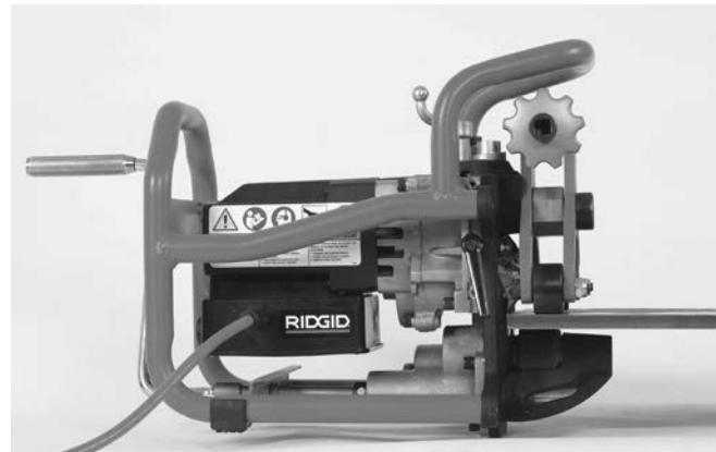
Şekil 16B – Pahlama Makinesinin Plakanın Üzerinde Kurulması
