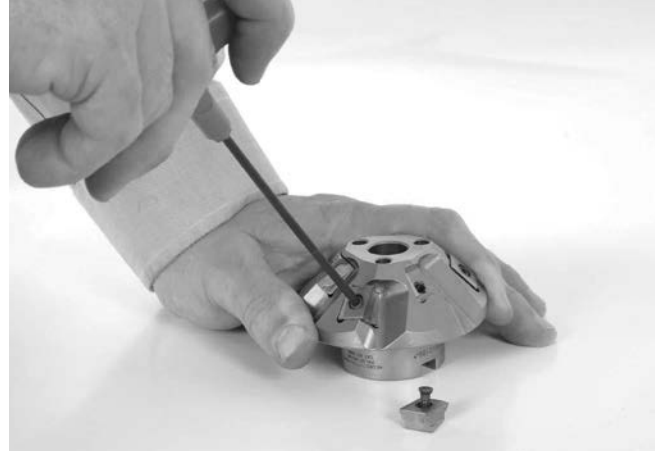
Şekil 24 – Kesici Bagaların Değiştirilmesi
