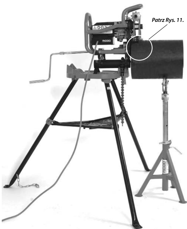
Rys. 12 – Nieruchoma ukosowarka, krótka rura, jeden stojak do rur
