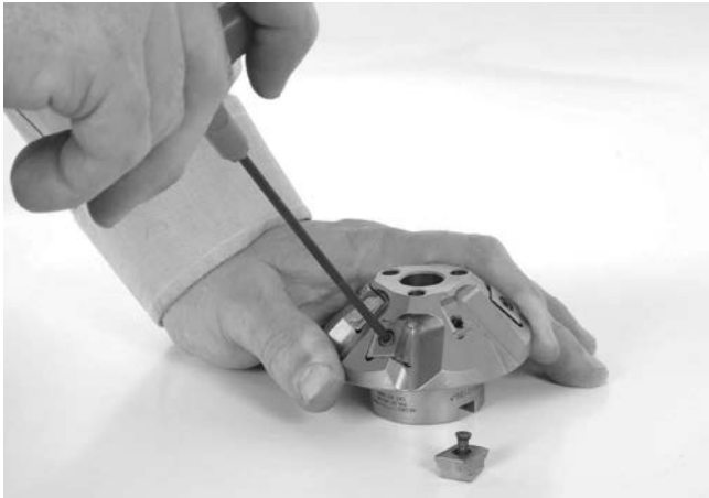
Figura 24 – Substituir Entalhes de Corte
