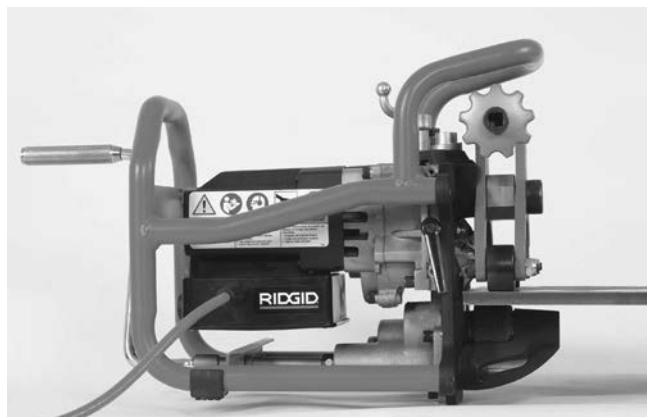
Kuva 16B – Viisteleikkurin asennus levyyn
