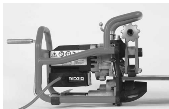
Rys. 16B – Zakładanie ukosowarki na płycie
