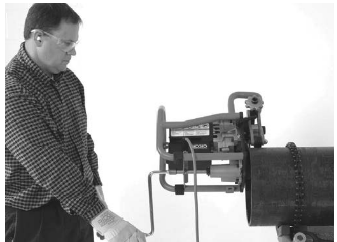
Figuur 20A – Afschuiven (Vastgezet werkstuk/Bewegend afschuinapparaat)
