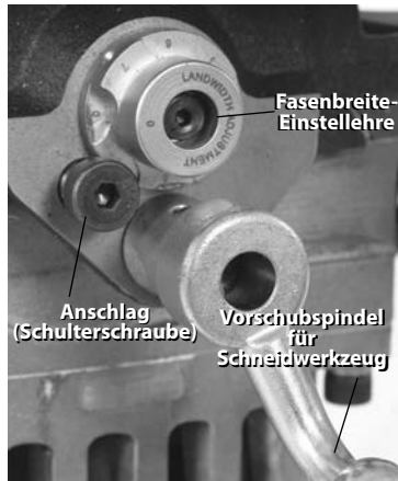
Abbildung 18 – Einstellung der Fasenbreite-Einstellehre
