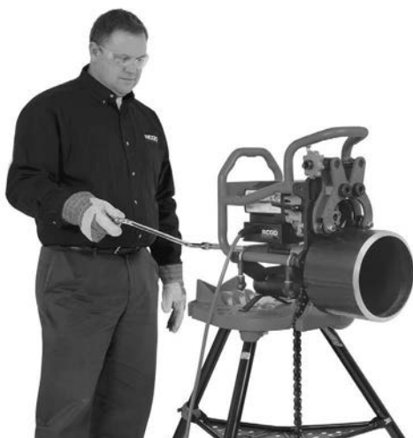
Slika 20C – Operacija obaranja ivica (fiksiran alat za obaranje ivica/rotirajuća cev)
