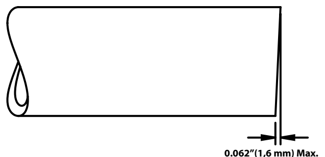
Abbildung 5 – Anforderungen hinsichtlich der Rechtwinkligkeit von Rohren
