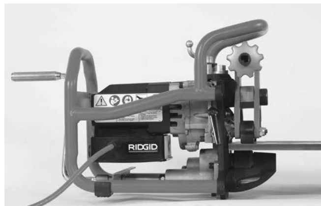
Abbildung 16B – Anbringen des Anfasgeräts an einer Platte
