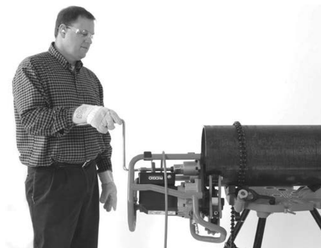
Figur 20B – Avfasningsfunktion (fast arbetsstycke/rörlig avfasare)
