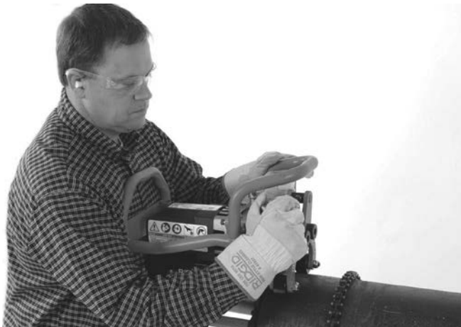
Figur 17A – Dra åt låsskruven med handkraft
