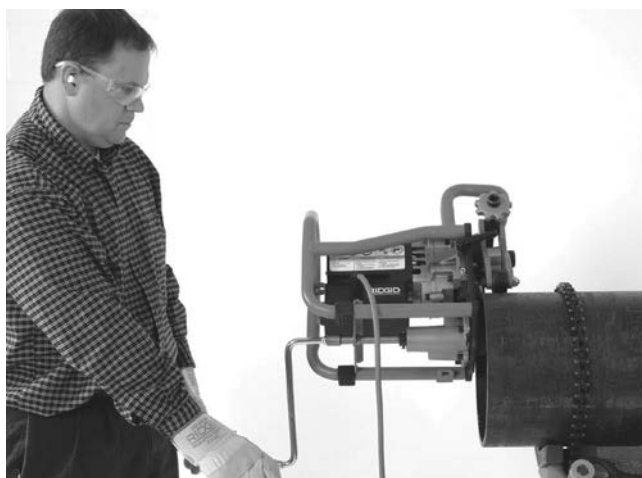
Figur 20A – Affasningsproces (fast arbejdsemne/bevægeligt affasningsværktøj)
