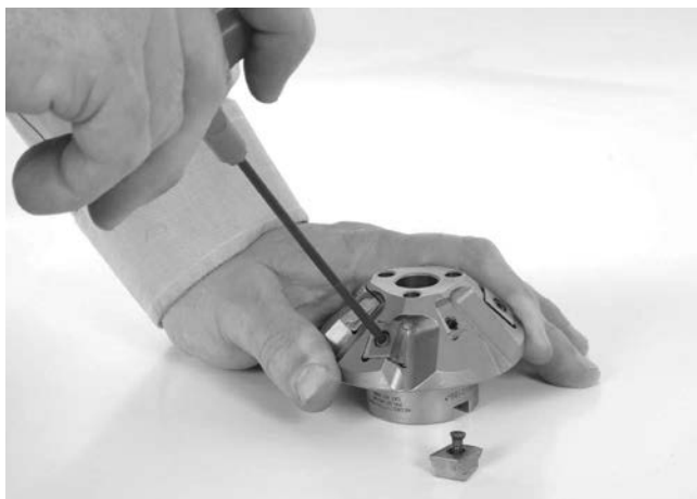
Slika 24 – Zamjena reznih umetaka
