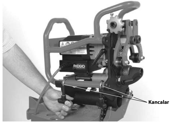
Şekil 9 – Pahlama Makinesinin Adaptöre Tespit Edilmesi
