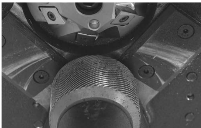
Рис. 22 – Чистые насечки ведущего ролика
