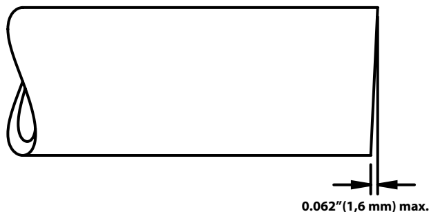
Obrázok 5 – Požiadavky na pravouhlosť rúrky
