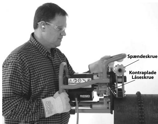
Figur 15A – Placering af affasningsværktøjet på et rør
