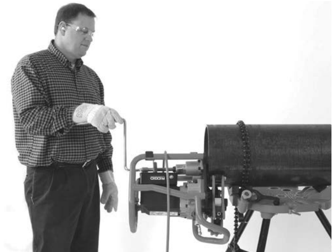
Εικόνα 20Β – Λειτουργία φρεζαρίσματος (Σταθερό τεμάχιο εργασίας/κινούμενο εργαλείο φρεζαρίσματος σωλήνων)
