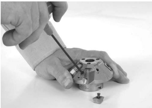
Figuur 18 – Snijkopinzetstukken vervangen
