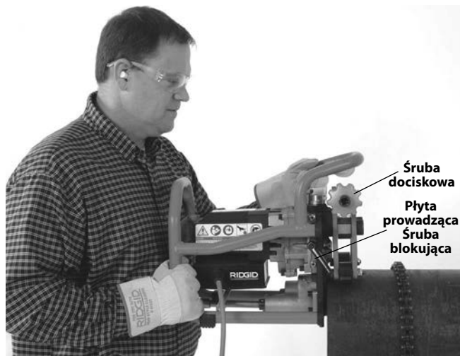
Rys. 15A – Ustawienie ukosowarki na rurze
