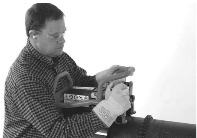
Abbildung 17A – Klemmschraube handfest anziehen
