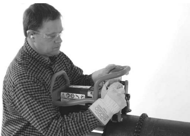
Slika 17A – Rukom zategnite stezni vijak
