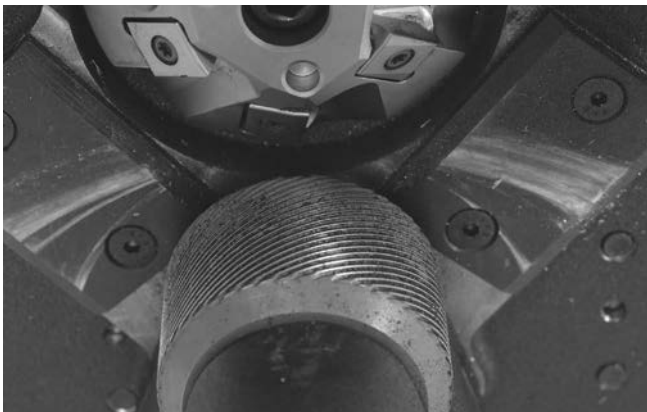
22. ábra – A hajtógörgő recézésének megtisztítása
