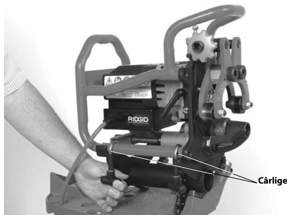
Figura 9 – Fixarea mașinii de șanfrenare la adaptor
