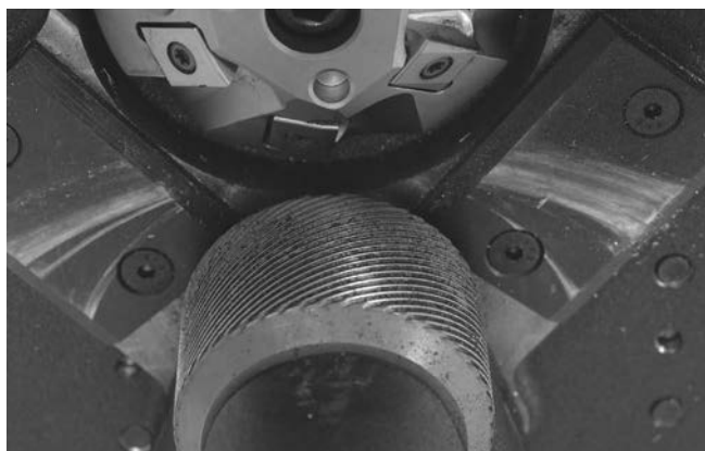
Εικόνα 22 – Καθαρίστε τις ραβδώσεις του κυλίνδρου μετάδοσης κίνησης
