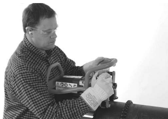
Obrázok 17A – Ručne utiahnite sťahovaciu skrutku
