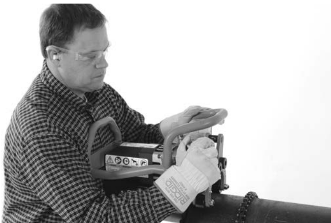
Figura 17A – Con la mano, apriete el tornillo de sujeción
