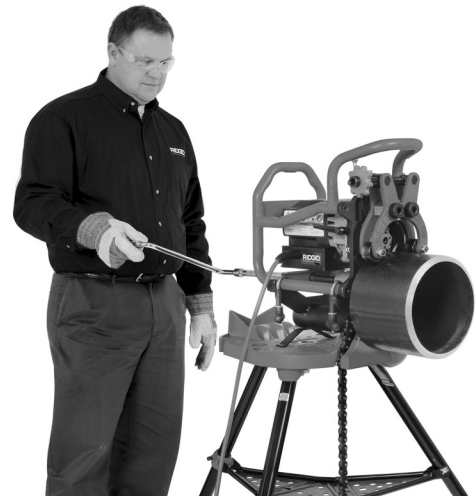
Figure 20C – Biseautage en cours (machine fixe/tuyau mobile)
