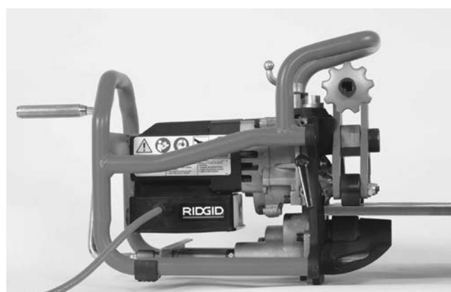
Figura 16B – Instalar o Biselador numa Placa
