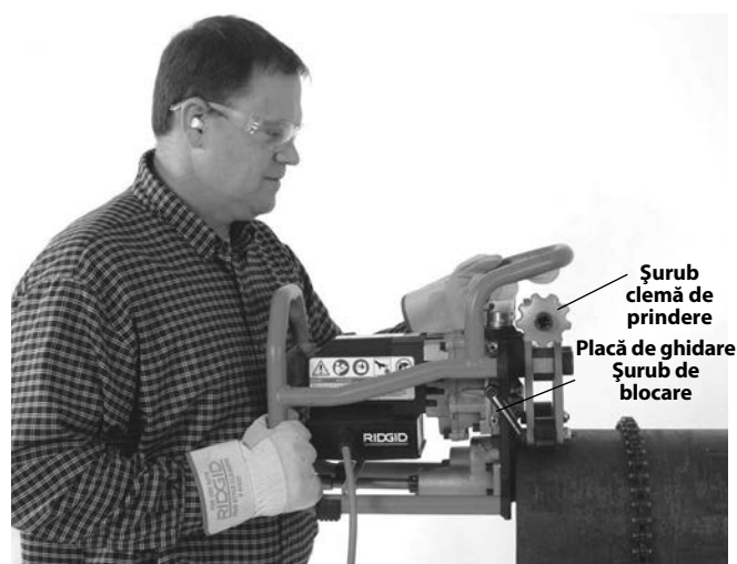
Figura 15A – Așezarea mașinii de șanfrenare pe țeavă
