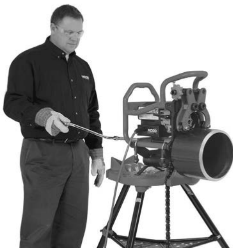
Figur 20C – Affasningsproces (fast affasningsværktøj/ roterende rør)
