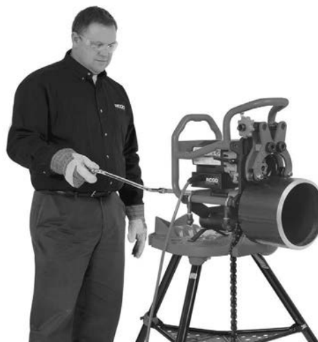
Figura 20C – Operazione di smussatura (Smussatrice fissa/Tubo ruotante)
