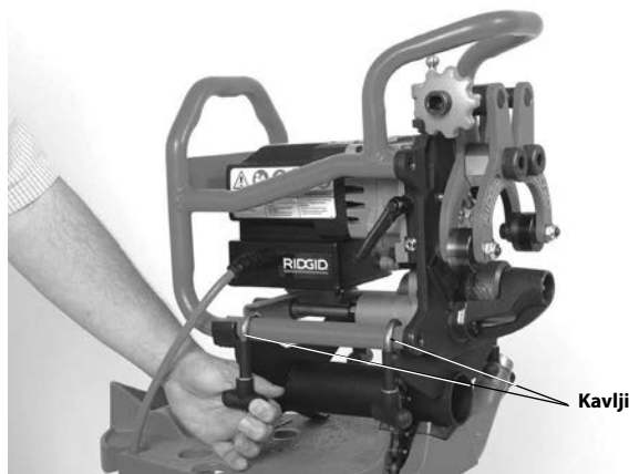
Slika 9 – Pritrjevanje posnemovalca robov na adapter
