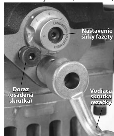
Obrázok 18 – Nastavenie nastavovacej šablóny pre šírku fazety
