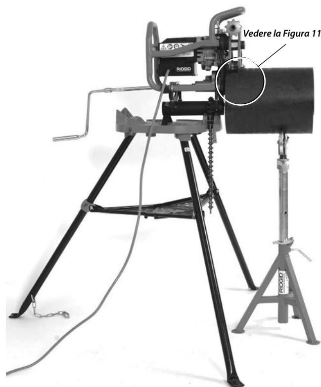
Figura 12 – Smussatrice fissa, Tubo corto, Un supporto per tubo
