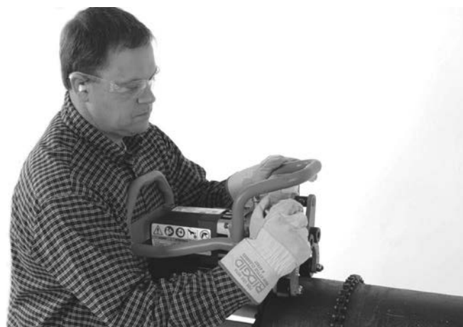
Figura 17A – Strângerea manuală a șurubului clemei de prindere
