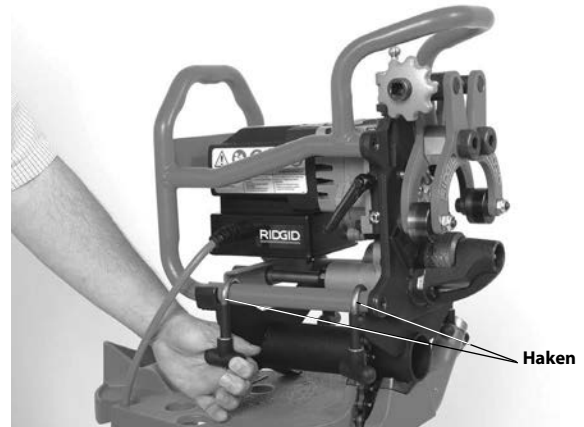
Figuur 9 – Het afschuinapparaat vastzetten op de adapter
