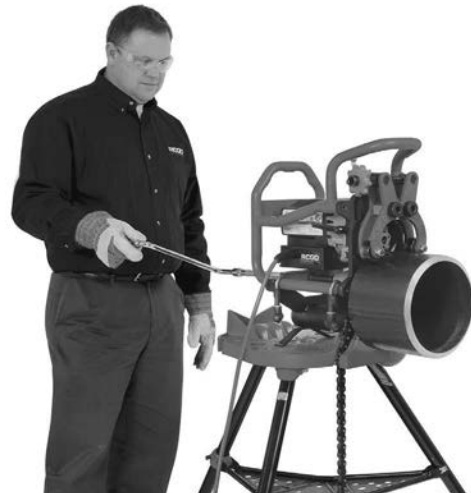
Figur 20C – Utfasing (Fast fasemaskin / Roterende rør)
