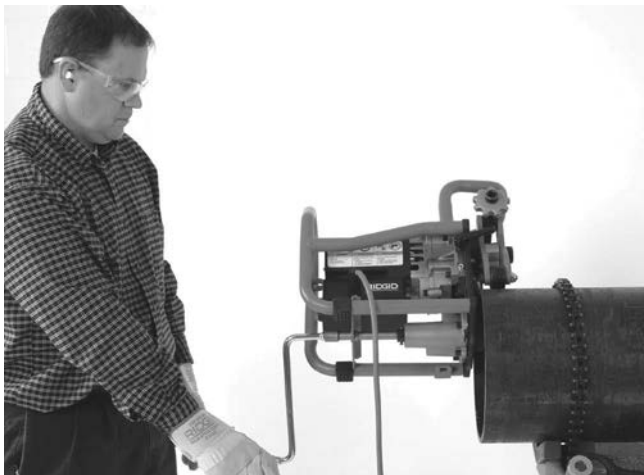
Figur 20A – Utfasing (Fast arbeidsemne / Bevegelig fasemaskin)
