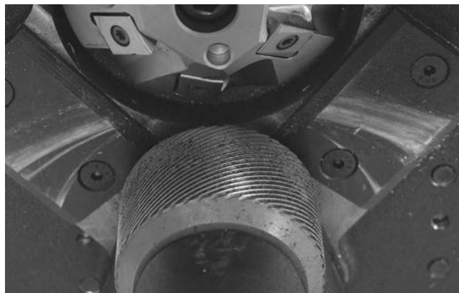
Rys. 22 – Czyszczenie radełek rolki posuwu
