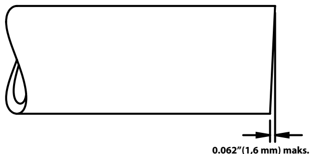
Slika 5 – Zahtjevi za rezanje cijevi pod pravim kutom
