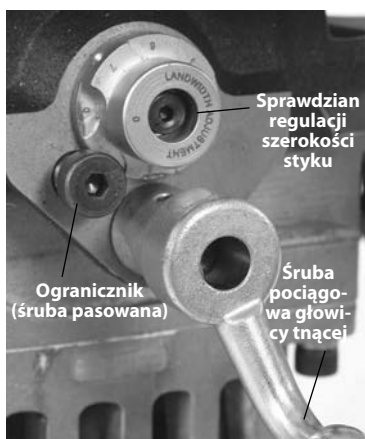
Rys. 18 – Ustawianie sprawdzianu regulacji szerokości styku
