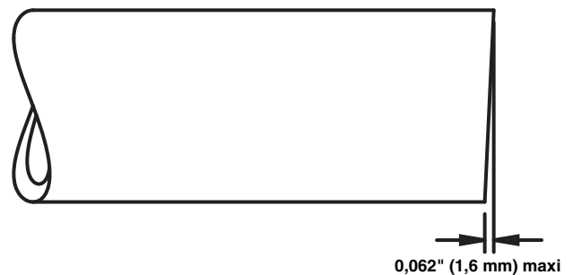
Figure 5 – Faux équerre maximal du tuyau
