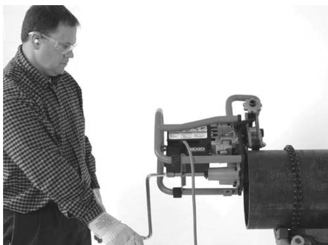
20A ábra – Leélezési művelet (Fix munkadarab/Mozgó leélezőgép)
