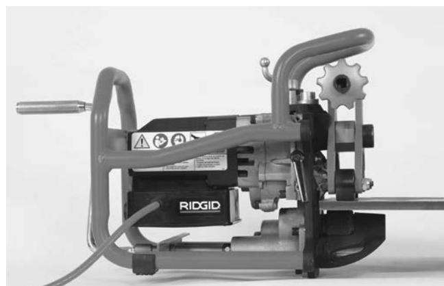
Figura 16B – Installazione della Smussatrice sul Tubo
