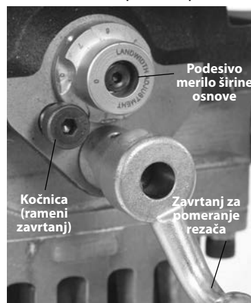
Slika 18 – Podešavanje podesivog merila širine osnove
