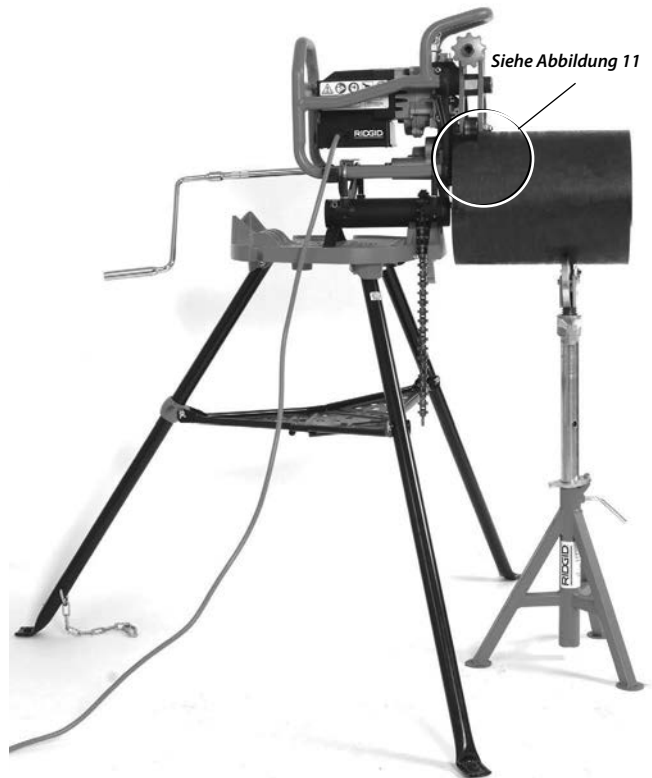
Abbildung 12 – Fixiertes Anfasergerät, kurzes Rohr, ein Rohrstände
