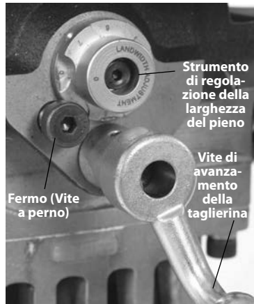
Figura 18 – Impostazione dello Strumento di regolazione della larghezza del pino
