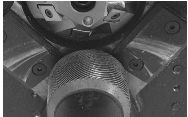
Figur 22 – Rengör drivrullens räfflor
