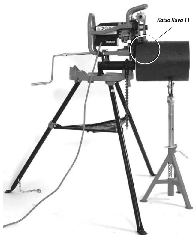
Kuva 12 – Kiinteä viisteleikkuri, lyhyt putki, yksi putkituki
