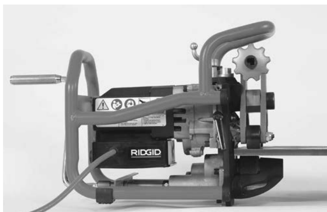
Εικόνα 16Β – Εγκατάσταση του εργαλείου φρεζαρίσματος πάνω σε πλάκα
