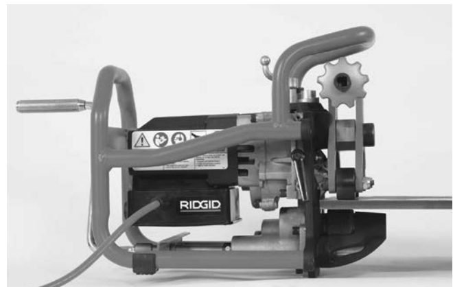
Figur 16B – Montera avfasaren på plåten
