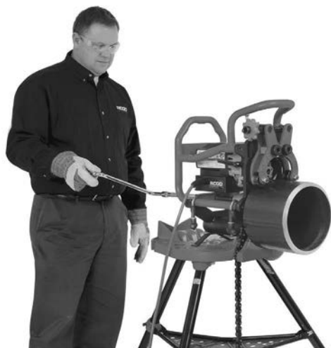
Figuur 20C – Afschuinen (Vastgezet afschuinapparaat/Roterende pijp)
