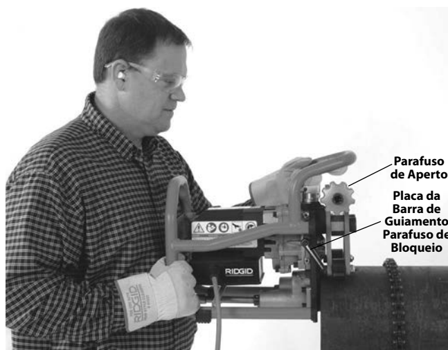
Figura 15A – Colocar o Biselador no Tubo
