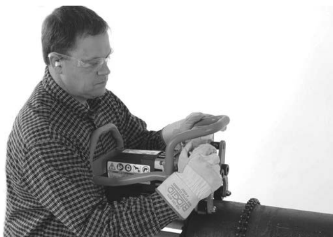
Rys. 17A – Ręczne dokręcanie śruby zaciskowej
