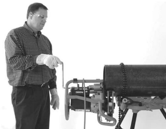
20B ábra – Leélezési művelet (Fix munkadarab/Mozgó leélezőgép)
