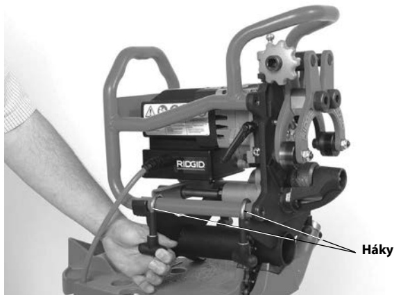
Obrázok 9 – Pripevnenie úkosovačky k adaptéru
