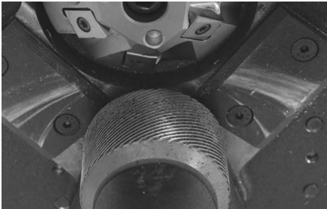
Figuur 22 – Reinig het groefoppervlak van de aandrijfrol
