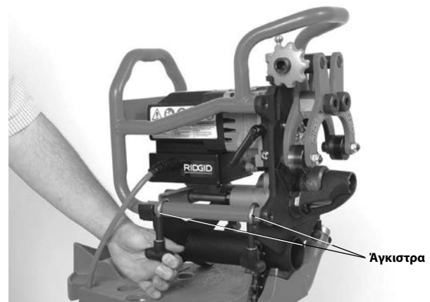
Εικόνα 9 – Τοποθέτηση του εργαλείου φρεζαρίσματος στον προσαρμογέα
