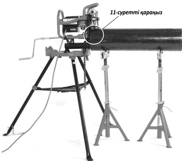
13-сурет – Тұрақты қиғаш кесу құралы, ұзын құбыр, бірнеше құбыр білтесі
