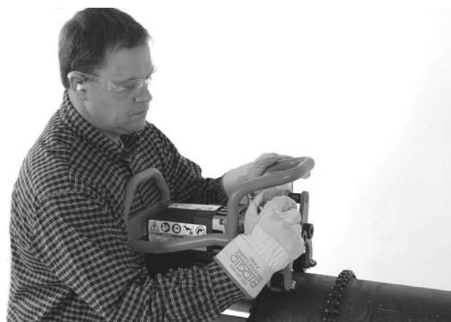
Slika 17A – Rukom zategnite stezni zavrtnj
