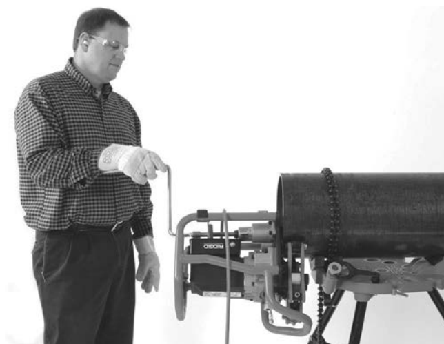
Obrázek 20B – Postup úkosování (fixní opracovávaný kus/pohyblivá úkosovačka)
