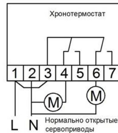
Клеммы 6 и 7 подключаются к сервоприводам системы встроенного обогрева (значок теплого пола на корпусе). Клеммы 4 и 5 подключаются к сервоприводам радиаторного отопления (значок радиатора на корпусе).
