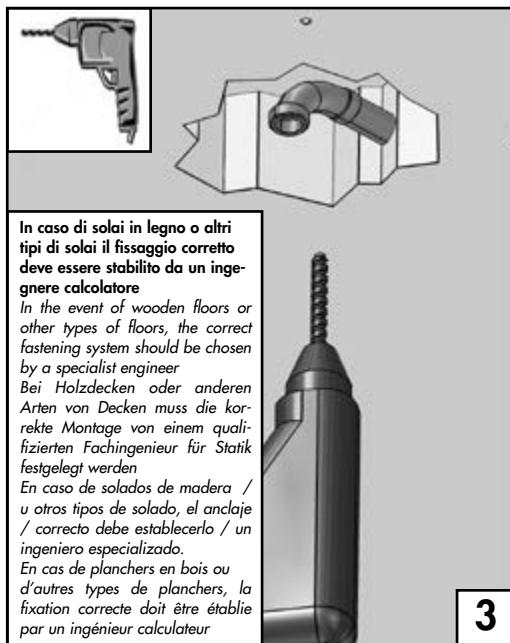
In caso di solai in legno o altri tipi di solai il fissaggio corretto deve essere stabilito da un ingegnere calcolatore
