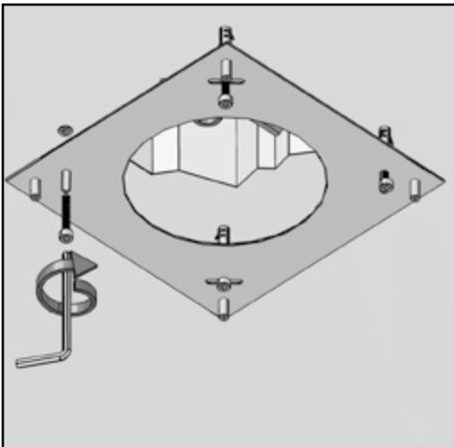
La tipologia di viti ed i tasselli di fissaggio dipendono dalla struttura del solaio su cui vengono fissati
