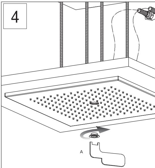
IT Utilizzare la chiave in dotazione "A" per installare il nebulizzatore
