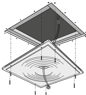
Подведите питающий кабель и закрепите светильник на крепящих профилях с помощью саморезов. Закручивайте саморезы аккуратно, чтобы не повредить светильник.
