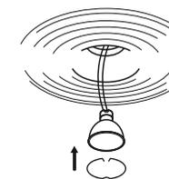
Вкрутите лампу в патрон Gu10 и закрепите её в светильнике с помощью стопорного кольца.
