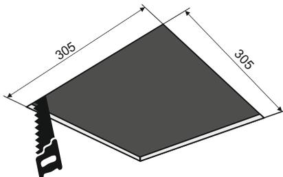
Вырежьте отверстие в гипсокартоне в соответствии с размерами указанными на рисунке.
