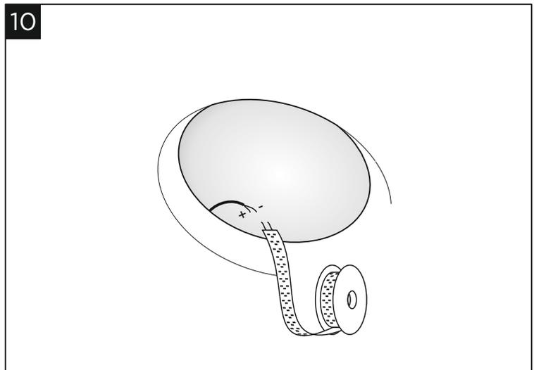
Подключите светодиодную ленту к источнику питания и наклейте её на техническую алюминиевую полосу внутри светильника.
