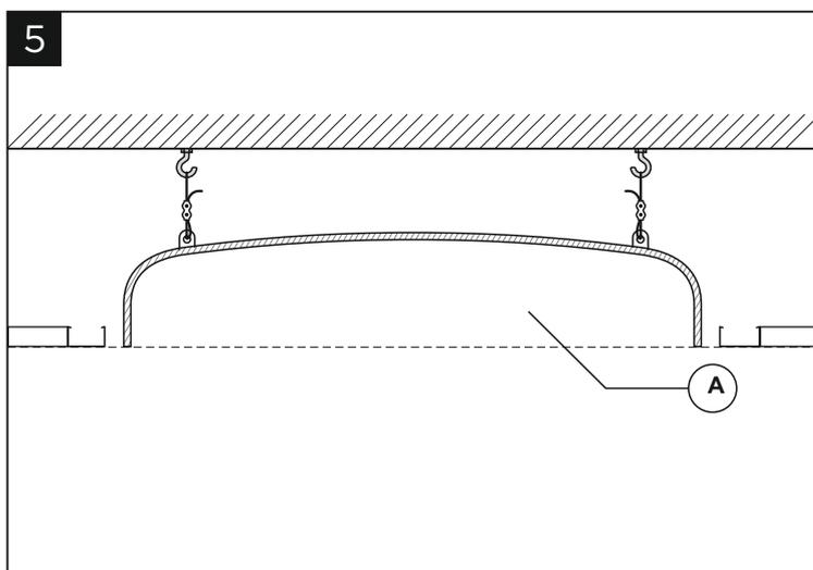
Закрепите страховочные тросы (входят в комплект светильника) в страховочных петлях на куполе. С помощью страховочных тросов подвесьте купол (А), как указано на схеме, за анкерный болт с крюком в один уровень с каркасом потолка для установки светильника.
