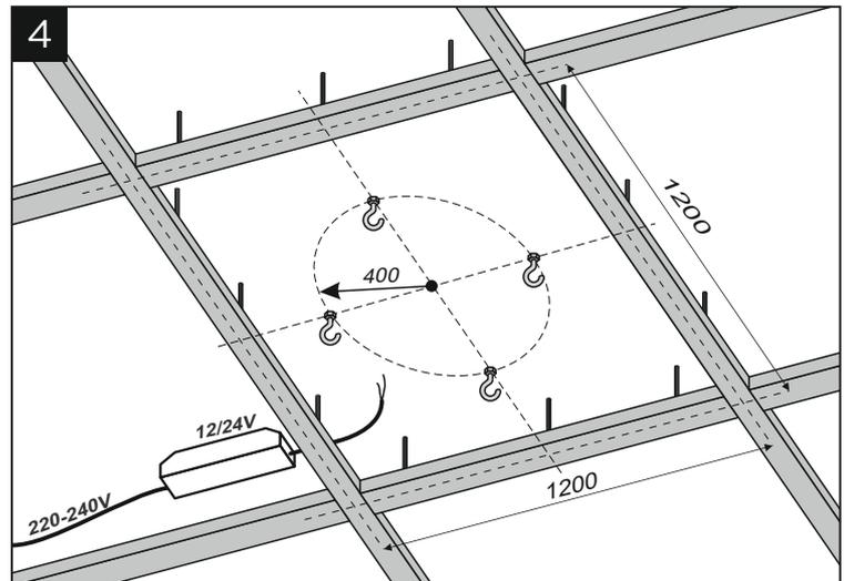
Установите анкерный болт с крюком (входит в комплект светильника) в черновой потолок с учетом радиуса их установки от центра светильника 330 мм, мест размещения страховочных петель на куполе и места подключения (боковое отверстие в куполе) источника питания к светодиодной ленте.
