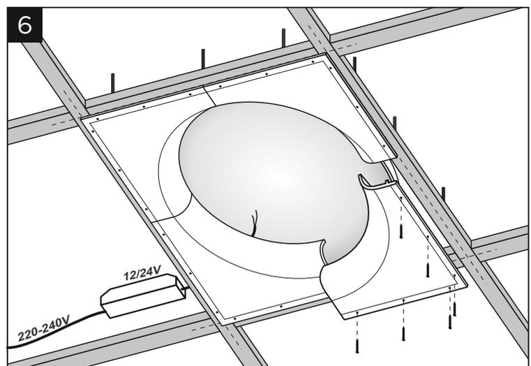
Закрепите основание светильника к каркасу потолка саморезами (входят в комплект светильника).
