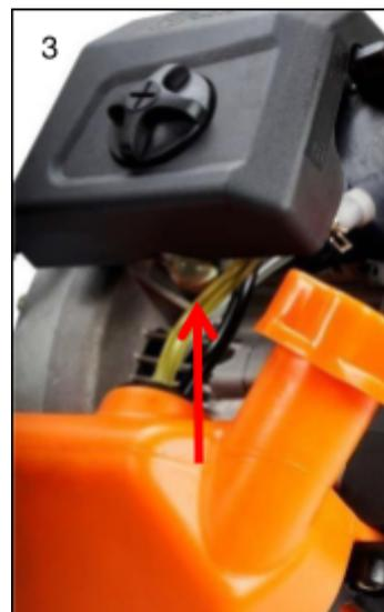
2. Установите рычаг для стартового клапана (дросселя) наверху в положении "ХОЛОДНЫЙ СТАРТ"
