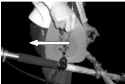
Плечевой ремень оснащён быстрым разъединительным устройством (см. рисунок). Вы можете быстро снять плечевой ремень, потянув за устройство быстрого расстёгивания.
