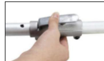
3). Поверните барашковый винт по часовой стрелке, чтобы закрепить соединение.
