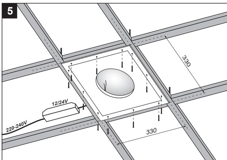
Закрепите собранный светильник на каркас потолка саморезами (входят в комплект светильника).
