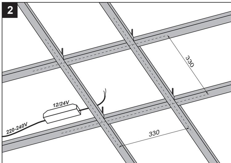
В запланированном месте размещения светильника соберите, заранее, на потолке по указанным на схеме размерам каркас для установки светильника. Подведите электрический кабель и подключите к нему источник питания.
