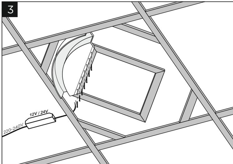
Закрепите 1/4 центральной части светильника к каркасу потолка саморезами (входят в комплект светильника)
