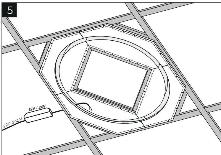
В таком же порядке закрепите остальные части светильника к каркасу потолка саморезами (входят в комплект светильника)
