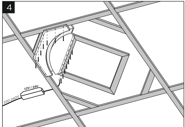
Затем закрепите 1/4 основания светильника к каркасу потолка саморезами (входят в комплект светильника)
