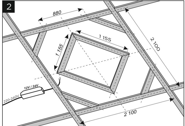
В запланированном месте размещения светильника соберите, заранее, на потолке по указанным на схеме размерам каркас для установки светильника.
