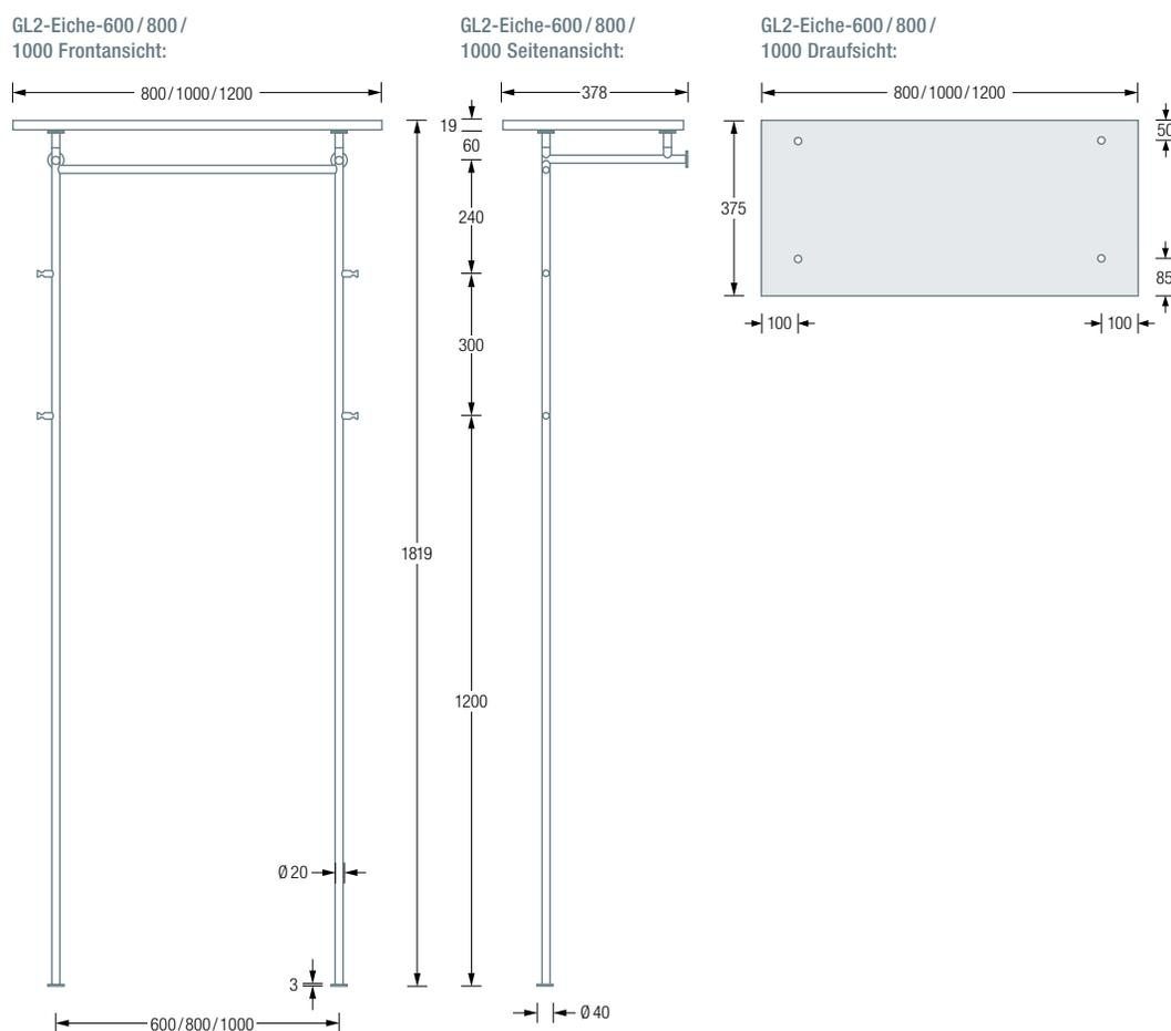
\*Edelstahl-Senkkopfschraube d 7 x 60 mm mit Rahmendübel 10 mm (HRD-CR 10x60).
