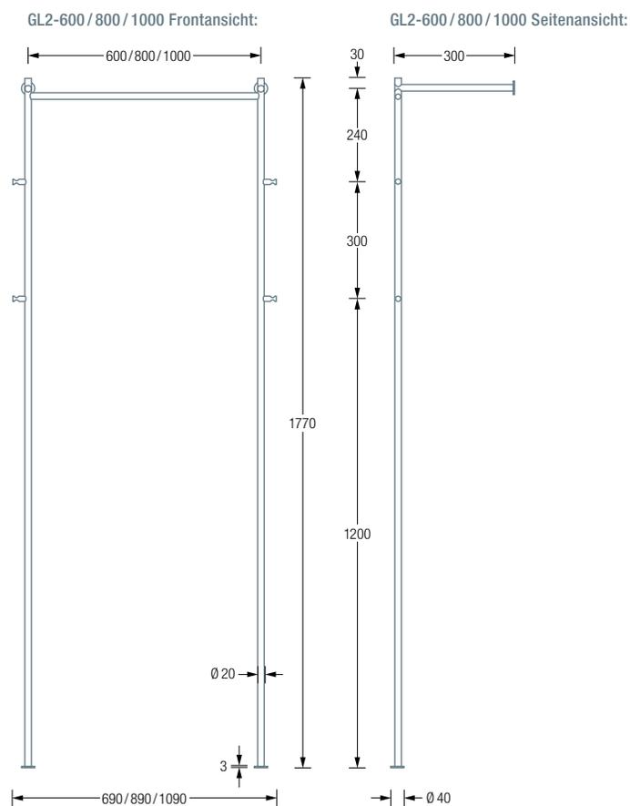
\*Edelstahl-Senkkopfschraube d7 x60 mm mit Rahmendübel 10 mm (HRD-CR10x60).
