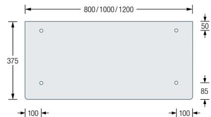
\*Edelstahl-Senkkopfschraube d 7x60 mm mit Rahmendübel 10 mm (HRD-CR 10x60).
