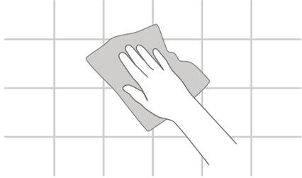
**1** Die Oberfläche des zu verklebenden Untergrundes muss sauber, trocken, frei von Fett, Staub, Kalk und klebstoffabweisenden Rückständen sein.
