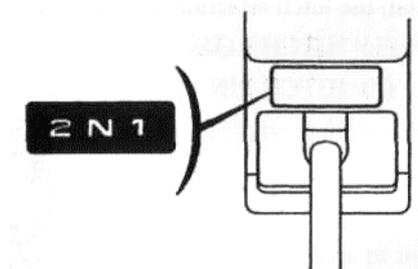
**Примечание:** Если рычаг переключения передач не перемещается в желаемое положение, выжмите рычаг сцепления и слегка переместите мотокультиватор, чтобы вернуть передачи в исходное положение.
