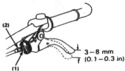
После регулировки затяните стопорную гайку соответствующим образом. Затем запустите двигатель и убедитесь в хорошей эксплуатационной работе рычага сцепления.
