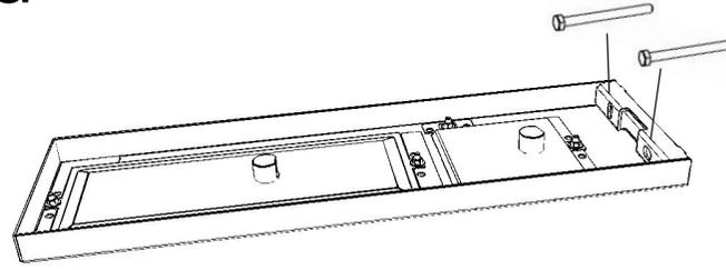
IT - Dal kit di fissaggio in dotazione prendete i due bulloni e predisponeteli nei due fori della staffa posteriore del soffione utilizzando anche le due ranelle che rimarranno poi tra i bulloni e la staffa.
