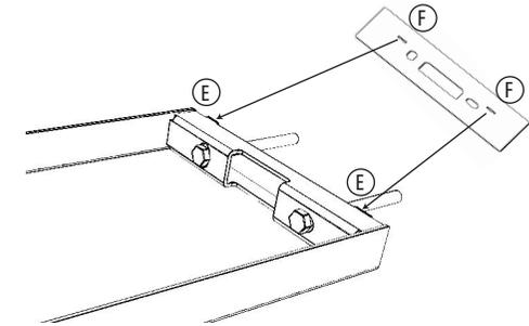
IT -posizionare il rosone al corpo soffione prestando attenzione nell'inserire le 2 linguette (E) presenti sul corpo principa le negli appositi alloggiamenti (F) del rosone stesso
