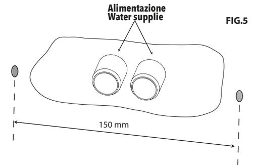
**IT** - A questo punto si può provvedere alla foratura della parete (Fig.5) utilizzando una punta da Ø 10 ed in seguito all'inserimento dei due tasselli (forniti).
