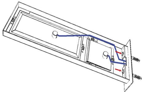
IT -Fissare il soffione al muro avvitando i bulloni;
