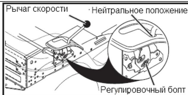
**ПРИМЕЧАНИЕ:** Для получения дополнительного пространства, что бы иметь доступ к регулировочному болту при необходимости опустите деку в самое нижнее положение.
