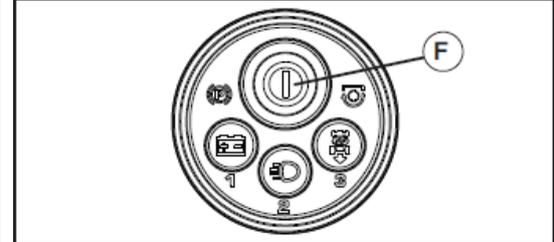
1. Нажмите и удерживайте (1) и (3) кнопки одновременно в течение примерно трех (3) секунд, пока кнопка SSI изменится до постоянного синего.
