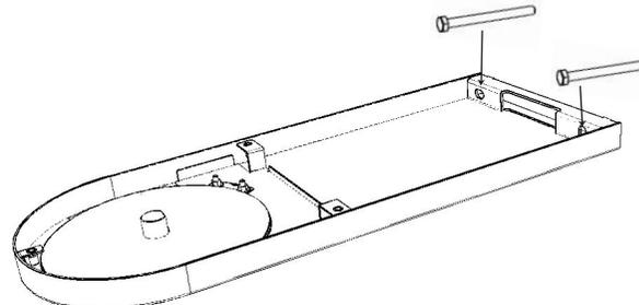
IT - Dal kit di fissaggio in dotazione prendete i due bulloni e predisponeteli nei due fori della staffa posteriore del soffione utilizzando anche le due ranelle che rimarranno poi tra i bulloni e la staffa.
