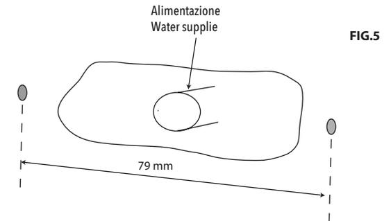
IT - A questo punto si può provvedere alla foratura della parete (Fig.5) utilizzando una punta da Ø 10 ed in seguito all'inserimento dei due tasselli (forniti).
