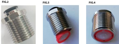
IT - Prelevare dalla confezione del vostro nuovo soffione il raccordo di alimentazione (Fig.2) preassemblato all'estremità dell'alimentazione. Avvitare lo stesso alla predisposizione della rete idrica preoccupandovi prima di inserire il limitatore di portata (Fig.3 e Fig.4) e che l'esagono del raccordo non fuoriesca dalla linea della parete: se ciò non fosse non riuscireste ad assemblare il soffione.
