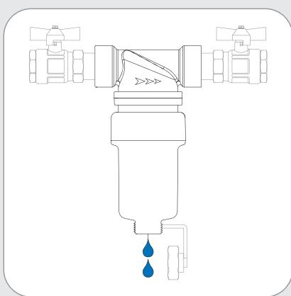
FDM-2 устанавливается так, чтобы основной корпус с картриджем/магнитом был обращен вниз, а крепления были расположены линейно.
