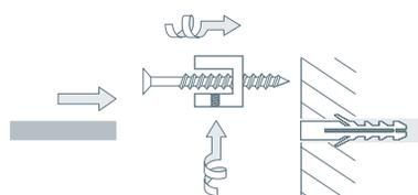
Montage unter Glas- oder Holzböden mit verdeckter Verschraubung:
