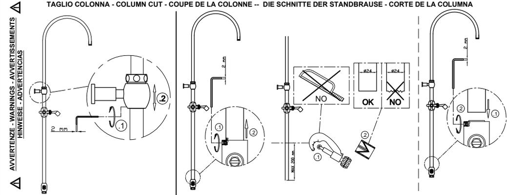
**TAGLIO COLONNA - COLUMN CUT - COUPE DE LA COLONNE -- DIE SCHNITTE DER STANDBRAUSE - CORTE DE LA COLUMNA**
