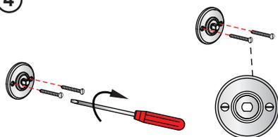
Fixez la base au mur en utilisant les vis en acier inoxydable. Veuillez vous assurer que la tête des vis soit parallèle au sol.
