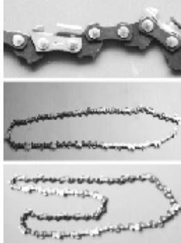
имеет хорошую прочность, остро заточенные режущие зубья. На поверхности цепи указано направление движения. При каждом использовании цепи необходимо обращать внимание на направление вращения цепи.
