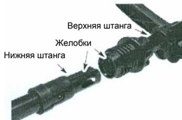
2. Соедините штанги, вдвинув нижнюю штангу в верхнюю до упора (штанги сцепляются).
