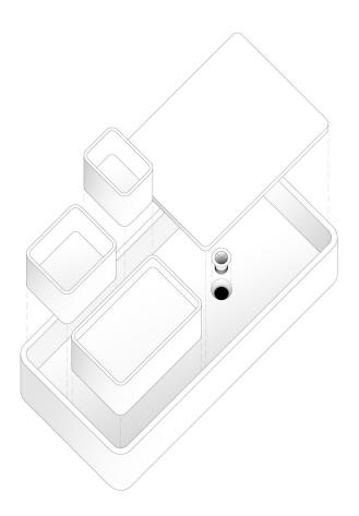
Bento va posizionato facendo attenzione ad allineare il foro piletta con il foro di scarico presente sul ripiano previsto.
