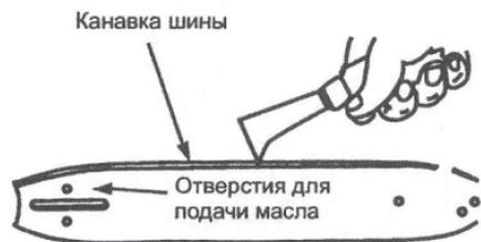
Если Вы пилите только одной стороной пилы, или Ваша пила нуждается в нажиме на неё при пилении, или работает на несоответствующем рекомендациям количестве смазочного масла, вполне возможно, что необходимо произвести техническое обслуживание шины.
