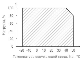
Рисунок 3. Максимальная допустимая нагрузка, % от мощности источника
