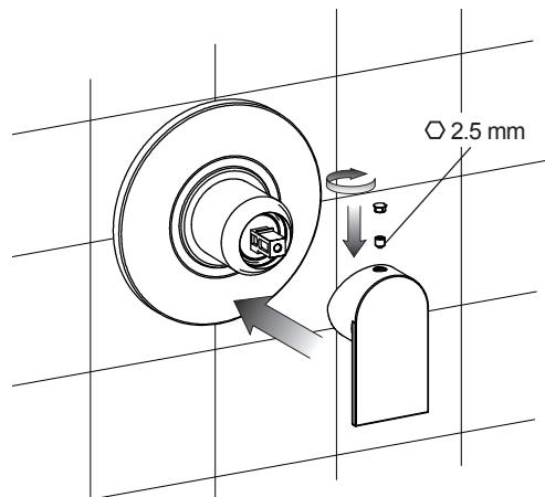
Togliere la protezione (C). Introdurre a pressione il rosone di finitura sul corpo (D). Inserire la maniglia sulla cartuccia fino ad arresto meccanico, e fissarla con il grano in dotazione (E).
