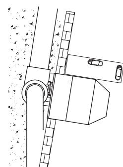
Prima di procedere all'inserimento nel muro del corpo, è necessario togliere i tappi di protezione dei filetti per permettere l'allacciamento alla rete idrica. Dopo di che inserire il corpo nel recesso precedentemente ricavato nel muro (A).
