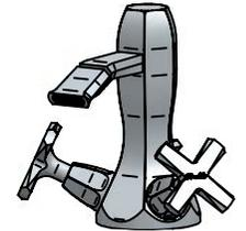
**Per installatore: Al fine di garantire la durata del prodotto installare rubinetti sottolavabo con filtro da pulire periodicamente. Effettuare risciacquo delle tubazioni prima di installare il prodotto (PUNTO 1)**
