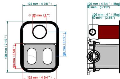
Boîte / Box Joint Plaque / Seal Plate Tube
