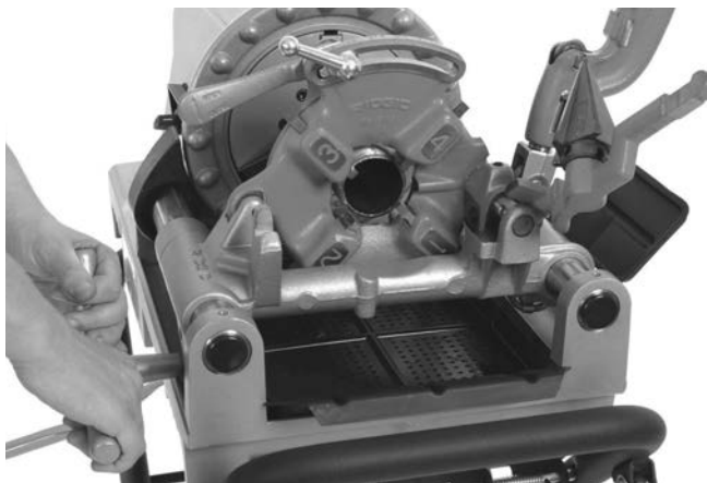
Рис. 24 – Нарезание резьбы на трубе (показана быстрооткрывающаяся резьбонарезная головка модели 811-А)
