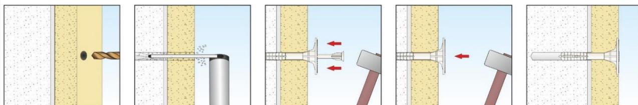
1 – Dopo aver posizionato il pannello isolante eseguire un foro in modalità di rotazione con una punta per ferro
