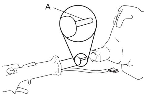
Осматривайте приводной вал (А) каждые 100 часов наработки и смазывайте его, если смазка недостаточна.
