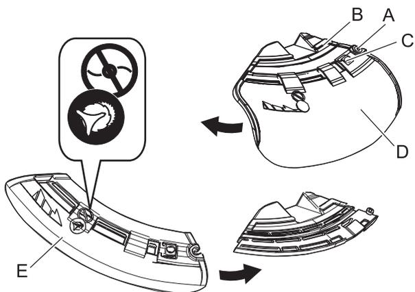
♦ Используются щитки двух типов, а именно: предназначенный исключительно для использования с лесочной режущей головкой и предназначенный исключительно для использования с металлическим полотном. С металлическим полотном следует использовать предназначенный для него щиток.
