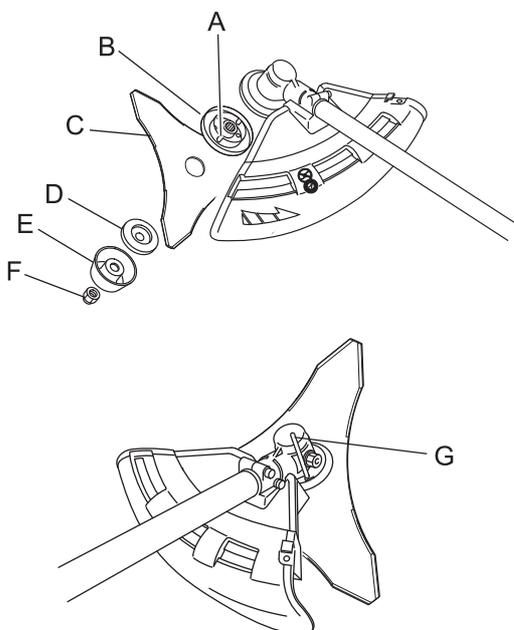
1. Необходимо осматривать ножи (С) перед установкой. Проверить их заточку. Тупые полотна могут повысить вероятность отскока бензокосы. Небольшие трещины могут разрастись и вызвать разлет частей полотна во время эксплуатации. Незамедлительно заменять ножи даже с небольшими трещинами.
