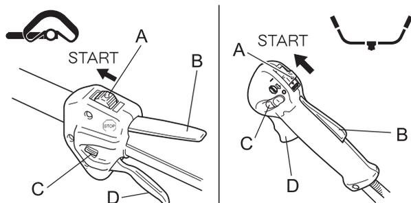
1. Переведите выключатель зажигания (A) в положение запуска двигателя.
