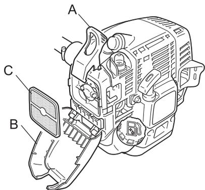
1. Закрыть заслонку. Разъедините фиксатор (А) и снимите крышку (В) воздухоочистителя.
