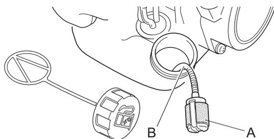
1. Используйте кусок металлической проволоки или что-либо подобное для извлечения топливного фильтра (А) через горловину топливного бака.
