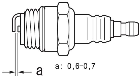
1. Проверьте зазор между электродами свечи зажигания. Правильный зазор составляет 0,6–0,7 мм.
