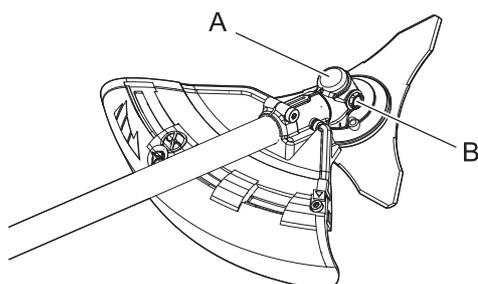
1. Снимите пробку (В) с угловой передачи (А).
