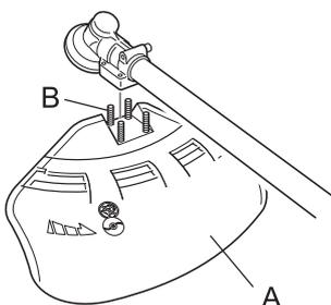
1. Установите защитный кожух (A) на монтажное место на угловой передаче и затяните 4 болта (B).
