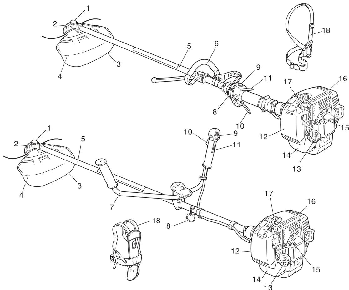
1. **Угловая передача:** имеет два привода для изменения угла оси вращения.
