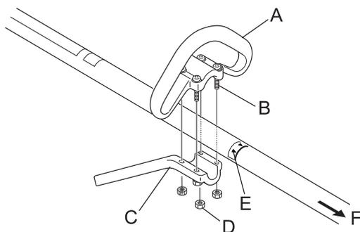
Установить ручку-скобу (А) и кронштейн (С) на трубку вала. Установите рукоятку в удобное рабочее положение и затяните болты (В).
