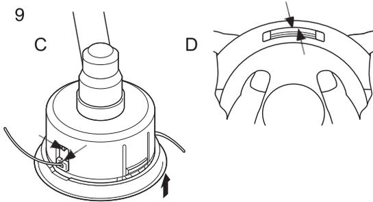
9. Установите крышку и корпус. (C) Совместите отверстия крышки с выемками корпуса и (D) и нажмите на защелки корпуса с соответствующими окнами крышки до полной фиксации.
