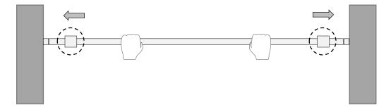
Person 2 dreht mit Hilfe des mitgeschickten Inbusschlüssel alle 4 Fixierungsschrauben fest. Anschließend ist die Montage abgeschlossen.
