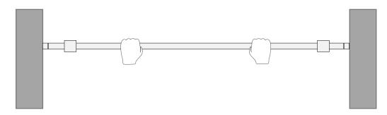
Person 2 schiebt die Wandlageraußenhülsen jeweils nach außen – bis ganz an die Wand. <u>TIPP:</u> Wenn Sie die Außenhülsen so drehen, dass die Fixierungsschrauben nach hinten zeigen, sind sie später von vorne nicht mehr zu sehen.
