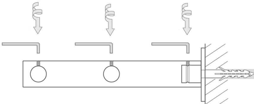
Fixieren Sie die nach oben zeigenden Madenschrauben – je Halter 3 Stück. Verwenden Sie dazu den Inbusschlüssel.
