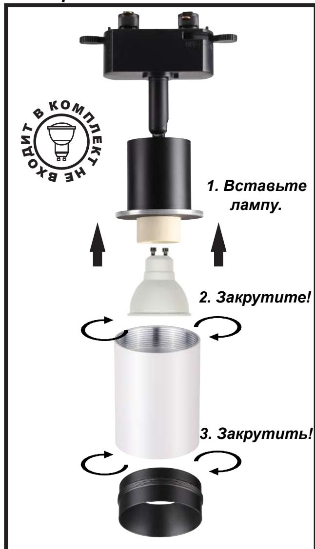
Схема сборки трекового светильника.
