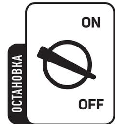
Переведите выключатель зажигания на двигателе в положение «OFF», двигатель остановится, затем переведите топливный кран в положение «ВЫКЛ».
