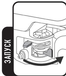
Переведите рычаг топливного крана в положение «ВКЛ», рычаг воздушной заслонки в положение «ЗАКРЫТО».
