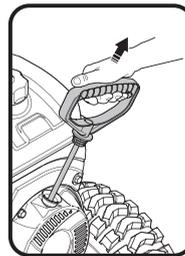
Вытяните ручку стартера примерно на 10–15 см, пока вы не почувствуете сопротивление, а затем запустите двигатель резким рывком.
