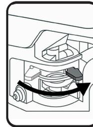
После того, как двигатель заведется и немного прогреется, плавно переведите рычаг воздушной заслонки в положение «ОТКРЫТО», приступайте к работе.
