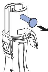
**3** Włożyć nasadkę zaciśkającą w moduł napędowy zaciskarki.
