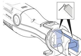
**5** Nadmiar środka smarującego usuwać chłonną ściereczką.
