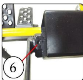
Смазывание подвижных точек ногового механизма поднятия нажимной балки (маслёнка)
