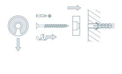
A ACHTUNG \*Zuvor den Bohrgrund fachgemäß überprüfen (z.B. auf Festigkeit, Stabilität, verlaufende Leitungen, Armierungen, Heizsysteme etc.).
