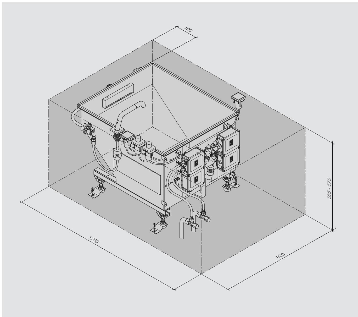
Dieses Montagebeispiel zeigt den Mindestplatzbedarf der FOOT BATH<sup>ATT</sup> Komponenten. In der Bemaßung ist neben dem Bauraum der Komponenten auch der benötigte Raum für die Montage und Anschlüsse berücksichtigt.
