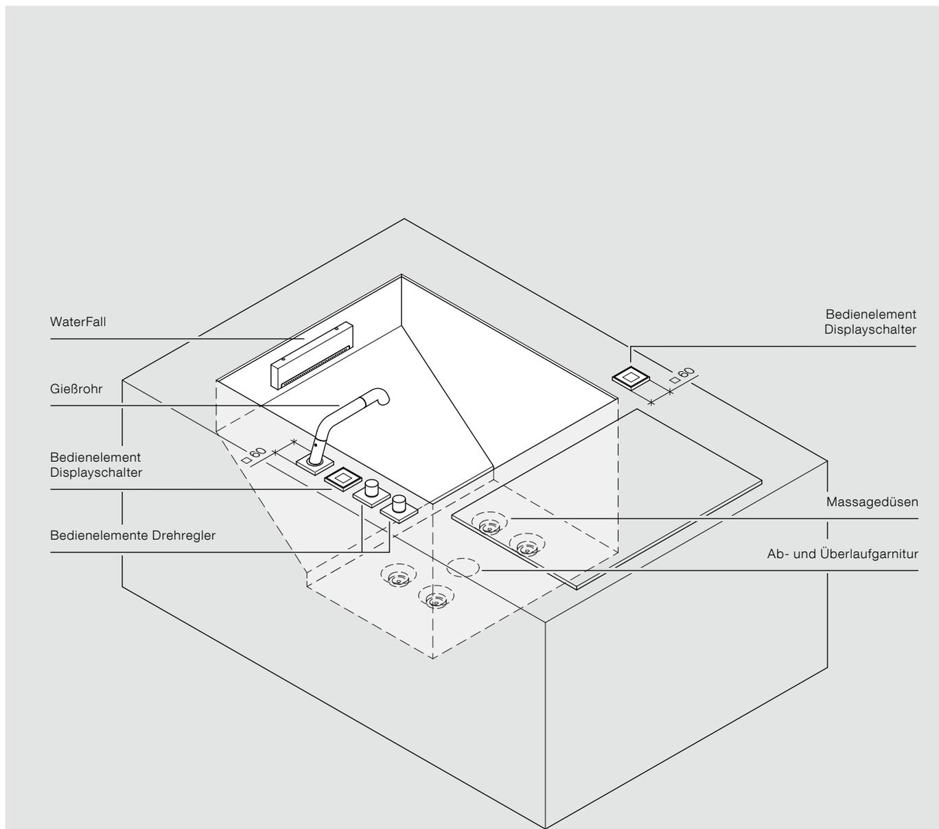
Diese Verortung stellt eine Empfehlung dar. Bedienelemente sind frei positionierbar unter Berücksichtigung der Kabellängen (Seite 11) und Revisionszugänge (Seite 6). Das Gießrohr muss auf dem linken Beckenrand platziert werden (von Sitzposition aus gesehen).
