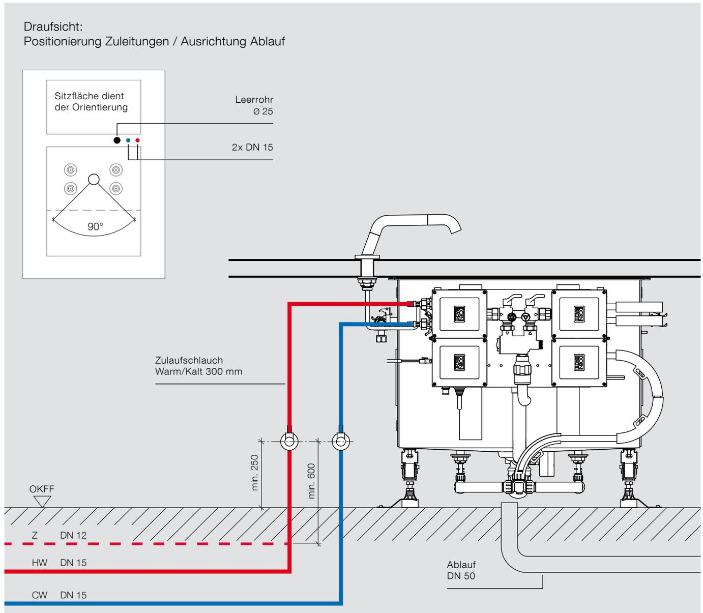
Beachten Sie abweichende, nationale Vorschriften. Separate Absperrung für die Warm- und Kaltwasserleitung über Eckventile mit integriertem Filter (im Lieferumfang). Die Ablaufleitung der Ablaufgarnitur kann in einem Winkel von  $90^\circ$  ausgerichtet werden (siehe Draufsicht).
