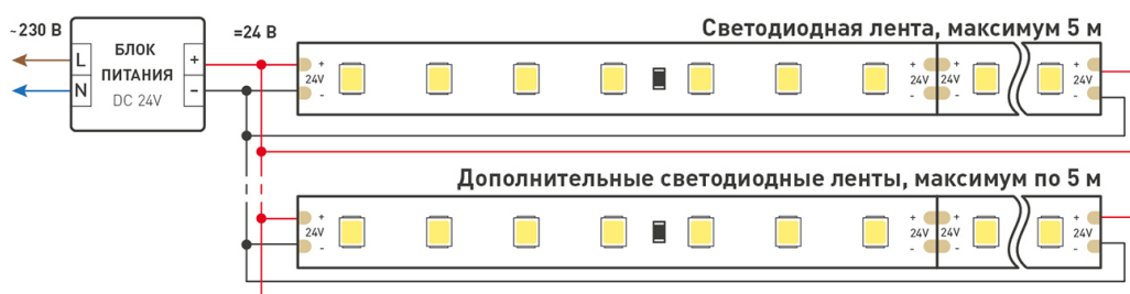
Схема 2. Подключение нескольких светодиодных лент с двух сторон. Рекомендуется использовать для обеспечения равномерного свечения ленты по всей длине.
