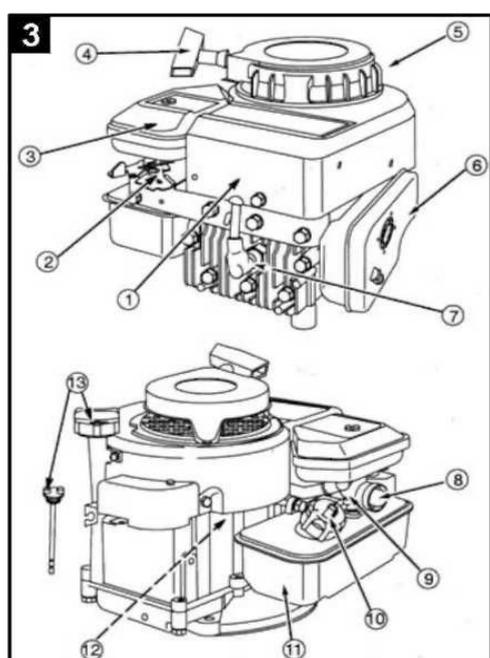
сгорания (1), с вертикальной осью коленвала и его основные части: (2) - рычаг дросселя; (3) - фильтр воздушный; (4) - стартер ручной; (5) -крышка верхняя(стартерная); (6) - глушитель; (7) - свеча зажигания; (8) - кнопка топливного насоса; (9) - карбюратор; (10) - пробка бензобака; (11) -бензобак; (12) - корпус двигателя; (13) - маслозаливное горловина см. рис. 3.
