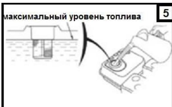
Для предотвращения травм или смерти от возгорания топлива выполняйте следующие инструкции (рис.5):
