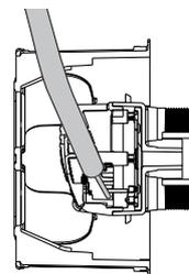
При подключении кабеля с задней стороны розетки необходимо уменьшить изгиб коаксиального кабеля, что позволит избежать разрыва непрерывности полного сопротивления и ухудшения характеристик.
