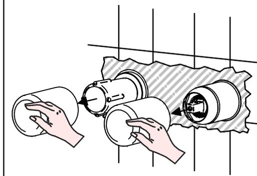
**Per installatore: Al fine di garantire la durata del prodotto installare rubinetti con filtro da pulire periodicamente. Effettuare risciacquo delle tubazioni prima di installare il prodotto PUNTO 1)**
