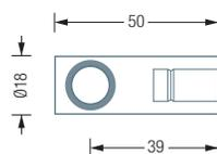
Montage auch hängend durch Schrankböden (mit M6 Senkkopfschraube) möglich – oder mit UV-Verklebung unterseitig auf Glasböden (mit Glasschraube) – bei Bestellung bitte angeben
